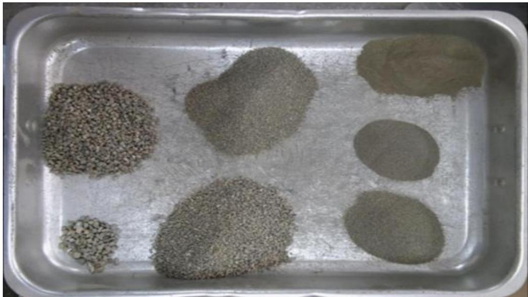
Figura N° 3: Granulometría del agregado fino
