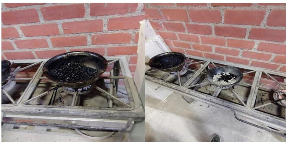
*Figura N 20:* Mezclado de mezcla asfáltica en caliente
