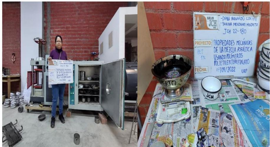
Figura N 24: Calentamiento del cemento asfáltico, moldes y determinación del peso del PET reciclado más el cemento asfáltico
