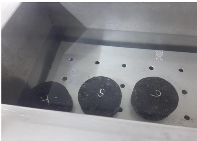
*Figura N 31:* Especímenes de mezcla asfáltica modificada en baño maría a 60°C
