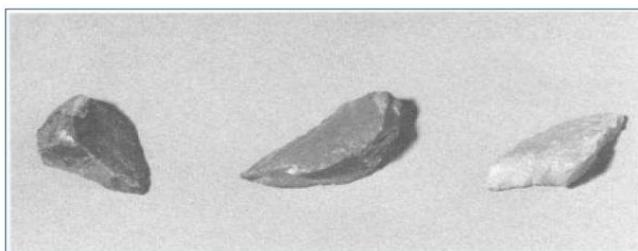
*Figura N 10:* Partículas Fracturadas (Bordes agudos, Superficies Alisadas)
