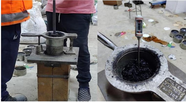
*Figura N 22: Compactación manual de las briquetas*
