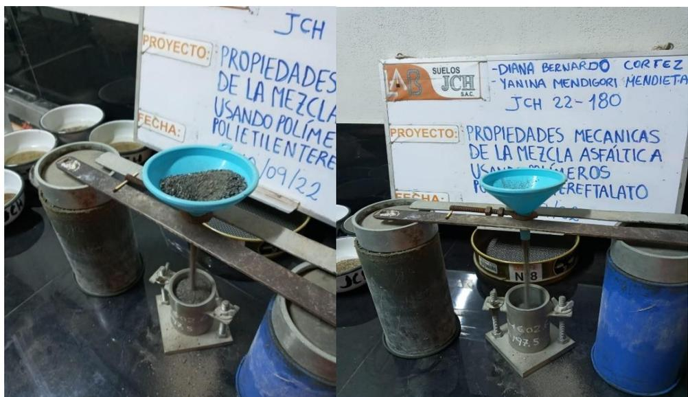
Figura N 13: Ensayo de Angularidad de Agregado Fino
