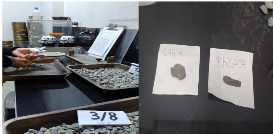
Figura N 8: Ensayo de partículas chatas y alargada
