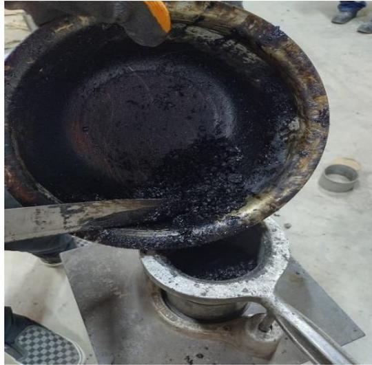
*Figura N 21:* Verificando la temperatura y vaciado de la mezcla asfáltica en los moldes.
