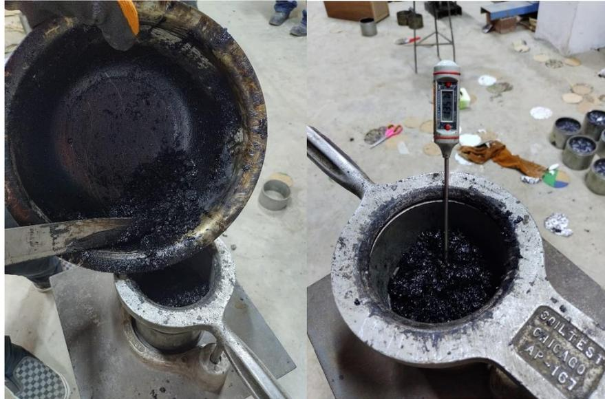
*Figura N 26:* Colocación de la mezcla asfáltica en el molde y revisando la temperatura de la misma.
