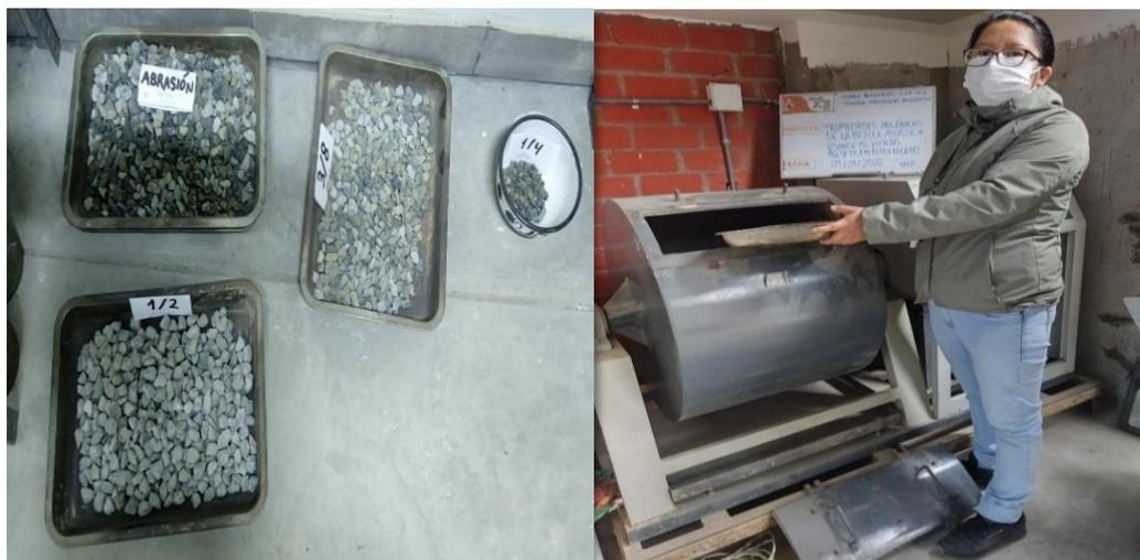
Figura N 4: Ensayo de abrasión de los Ángeles
