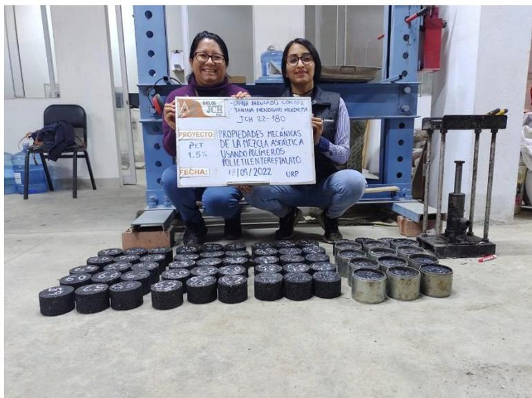
Figura N 28: Producción de la Briquetas Marshall convencional y con adición de al 0.5% de PET, 1% de PET,1.5 de PET.
