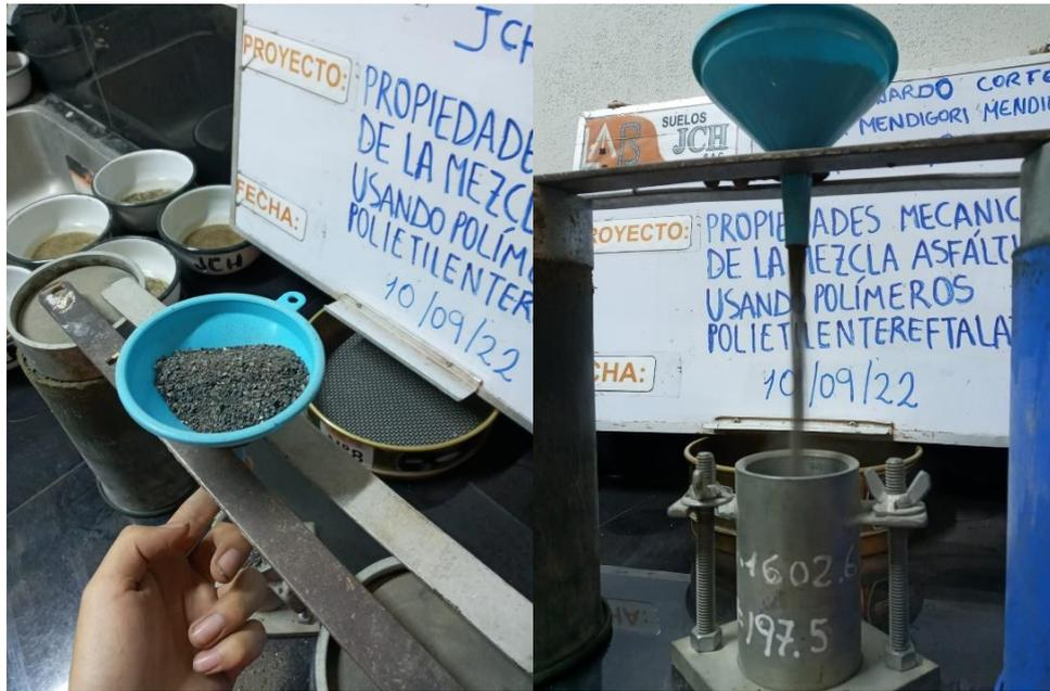
*Figura N 14:* Ensayo de Angularidad de Agregado Fino.
