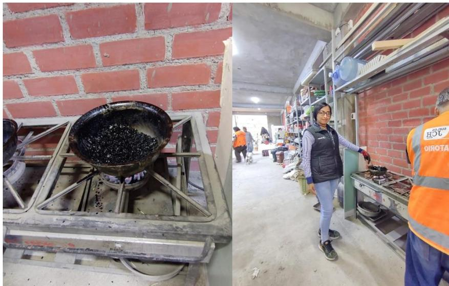
*Figura N 25:* Calentamiento de los componentes de la mezcla asfáltica y mezclado de los mismos.
