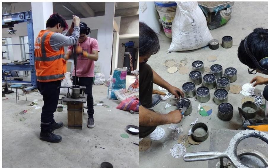
*Figura N 27:* Compactación mecánica manual y numeración de las mismas
