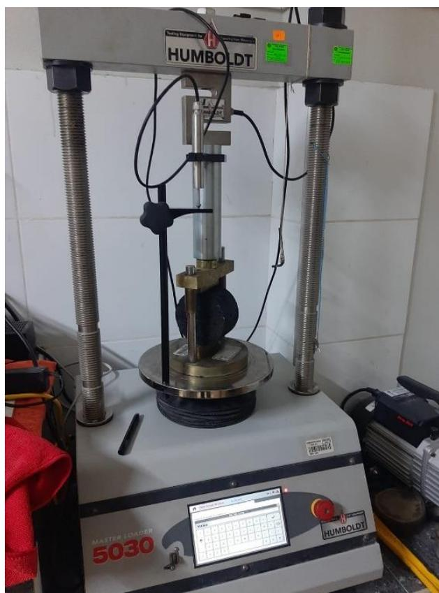
*Figura N 32:* Rotura a tracción indirecta de los especímenes
