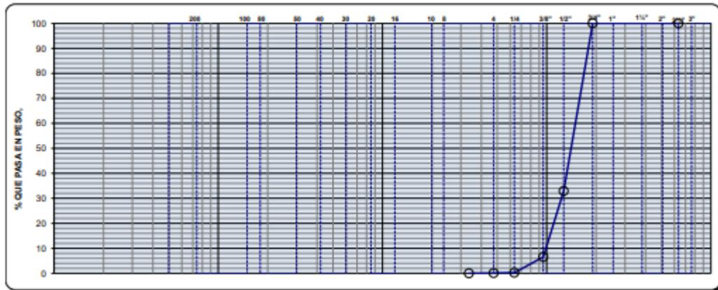
Figura N 60: Curva Granulométrica del agregado grueso
