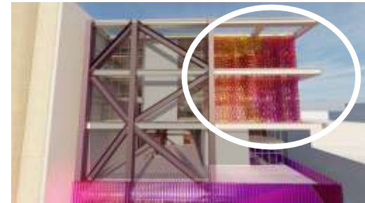
Esquina crítica de incidencia solar con cobertura de protección solar
