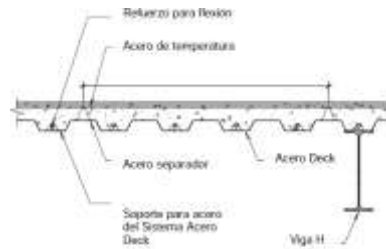
DETALLE 2 : Acero Deck
