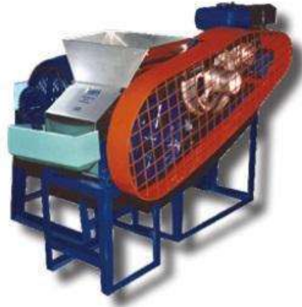
Ilustración 73: Máquina multiusos, se encarga de pelar, seleccionar y lavar los granos.
