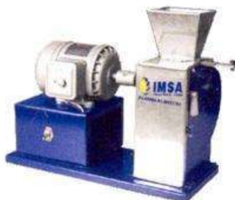
Ilustración 78: Pulpadora, máquina que se encarga de pelar los granos de café.
