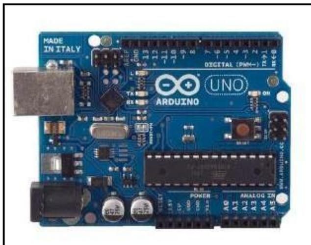
Figura N°8: Tarjeta Arduino Uno
