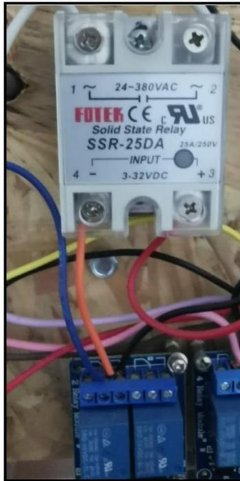
Figura N°36: Relé estado sólido y módulo Relé para electrobomba
