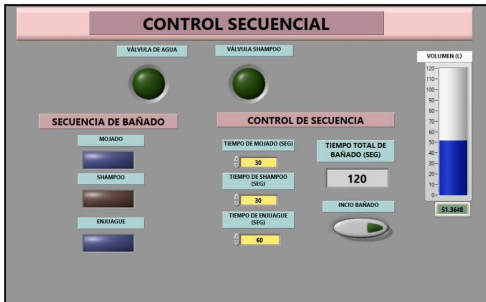
Figura N°77: Respuesta del controlador secuencial para un T=120 segundos
