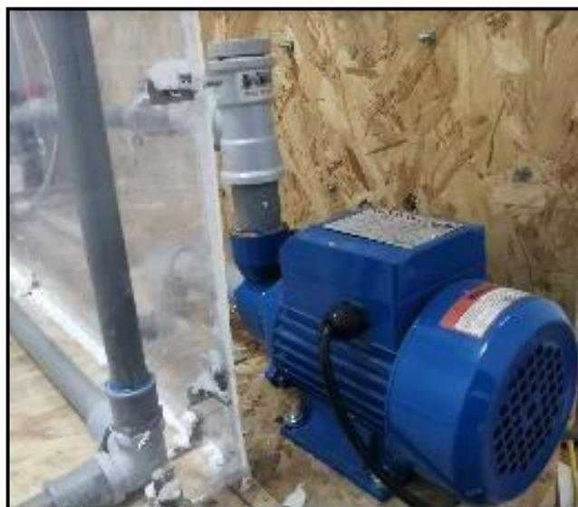
Figura N°12: Electrobomba de 0.5Hp
