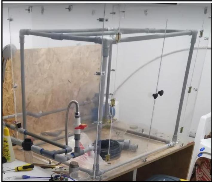
Figura N°21: Implementación de la cabina del prototipo de bañera
