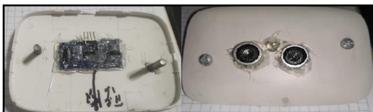
Figura 30: Sensor de nivel ultrasónico
