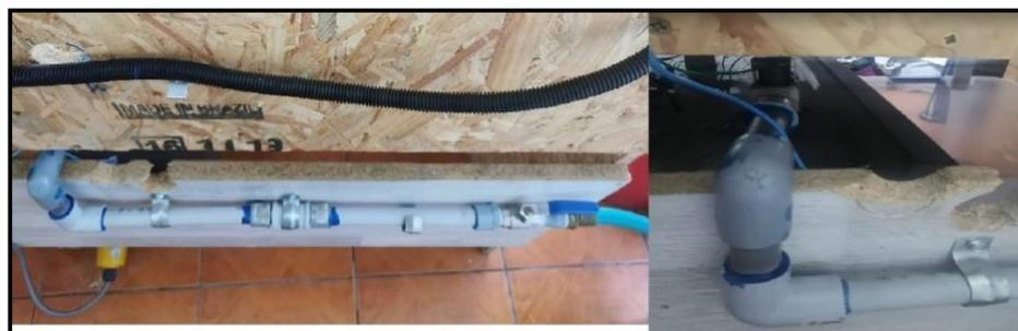
Figura N°25: Ingreso de agua al Prototipo de Bañera
