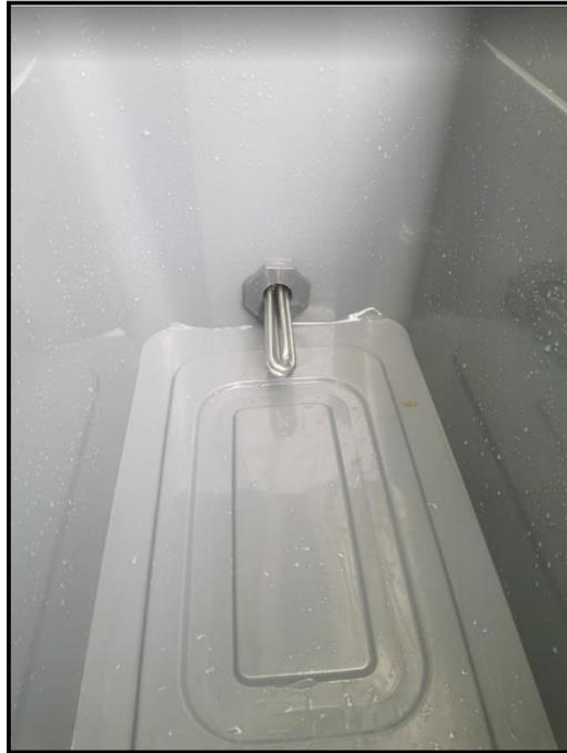
Figura N°37: Resistencia implementada en el tanque
