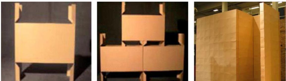
*Nota:* La figura muestra el funcionamiento de la pared de apilamiento de cajas de cartón. Fuente: Cassandro-Cajiao (2018)
