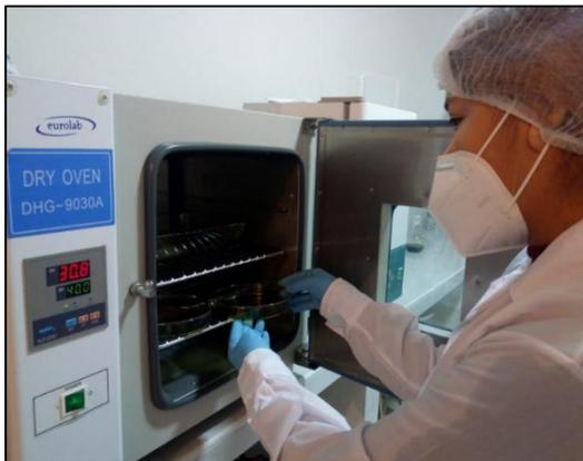
9. Evaporación del solvente en la estufa por 48 Hrs
