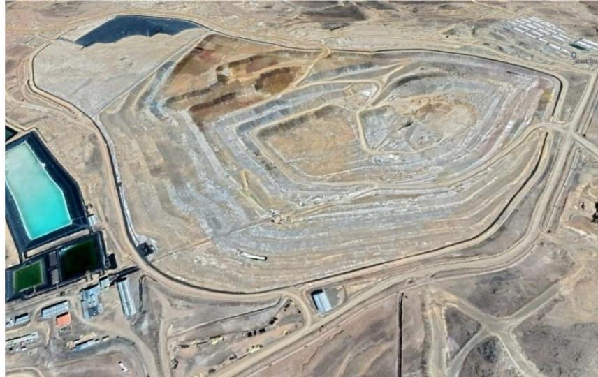
Figura N° 23: Vista panorámica del Pad de lixiviación existente
