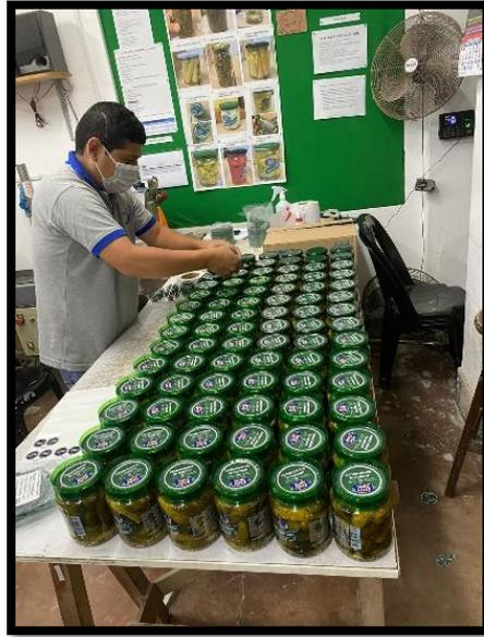
Figura N° 36. Operario colocando precintos.
