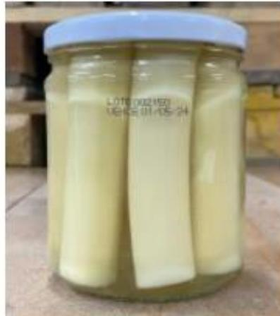
E. **Colocación de precinto de seguridad:** Consta en colocar el precinto de seguridad en la parte superior del frasco, mientras este pasa por la faja transportadora. La persona que desarrolla esta tarea es el maquinista, y deberá tener cuidado al poner este precinto cerca al túnel de calor. La colocación del precinto debe estar a la altura media de la tapa del frasco (no muy arriba ni muy abajo), logrando que el precinto se pueda sellar correctamente en la siguiente tarea.
