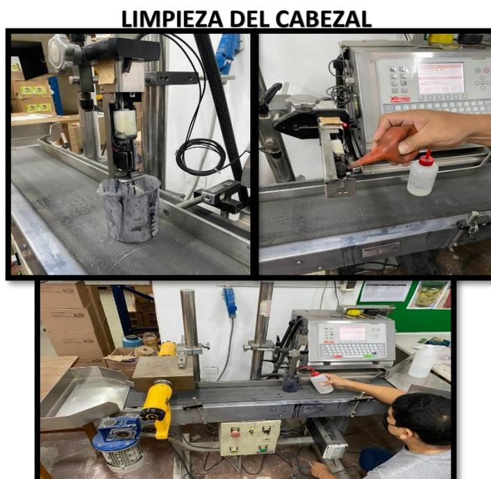
Figura N° 58. Limpieza del cabezal
