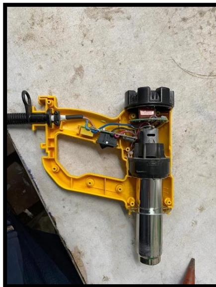
Figura N° 60. Partes internas de la pistola de calor.
