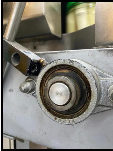
Figura N° 59. Lubricación de polea.
