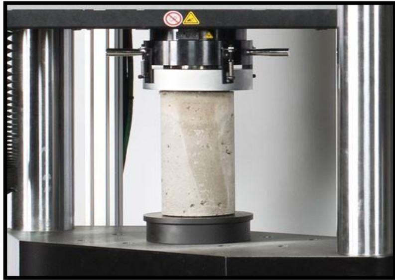
Figura N° 4: Ensayo de Compresión
