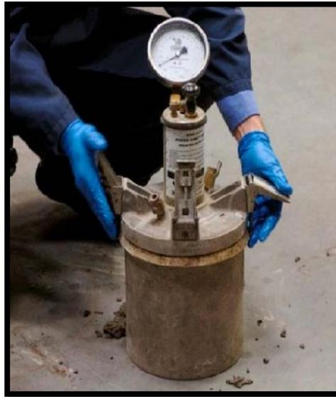
Figura N° 3: Ensayo de contenido de aire
