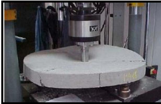
Figura N° 52: Ensayo de panel circular EFNARC
