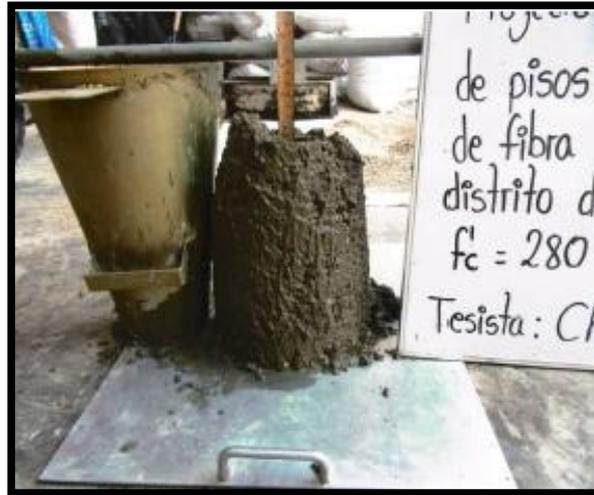
Figura N° 61: Ensayo de Slump de concreto con fibra de acero
