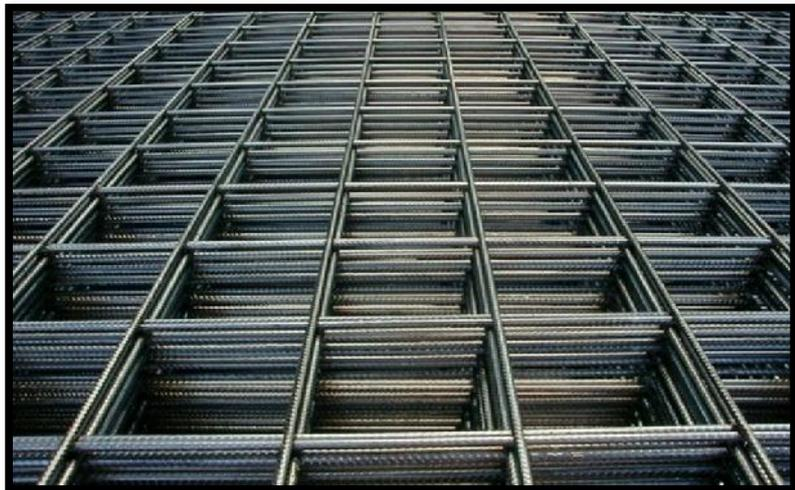
Figura N° 9: Mallas electrosoldadas
