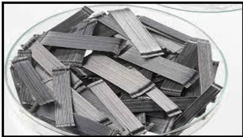
Figura N° 11: Fibras de acero Z aditivos
