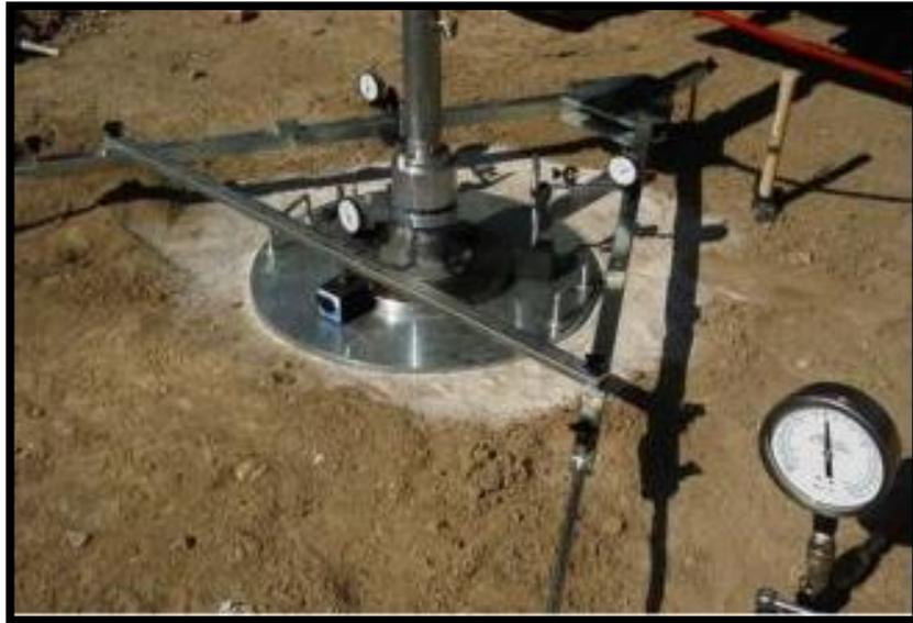
Figura N° 35: Ensayo de placa de carga
