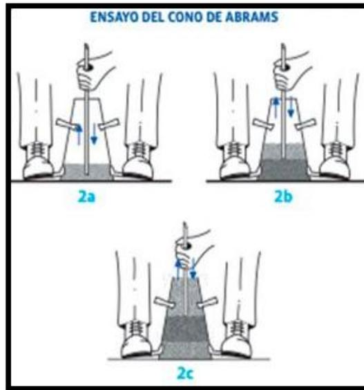
Figura N° 1: Ensayo de cono de Abrams
