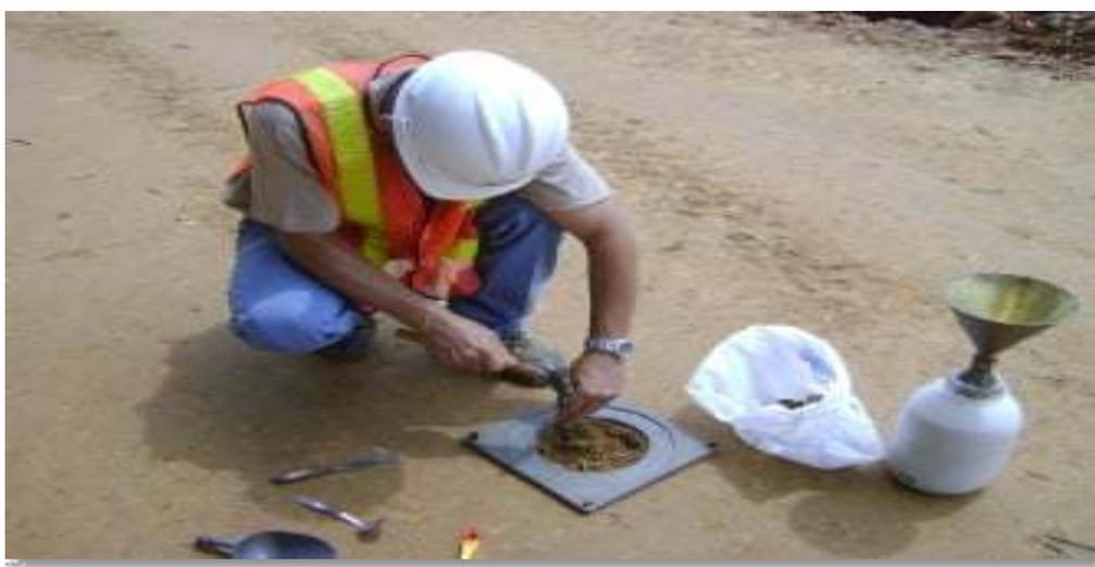
Figura N°49: Ensayo de densidad método cono de arena
