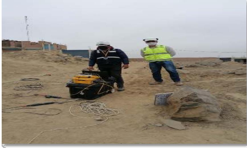
Figura N°52: Equipo de Refracción Sísmica
