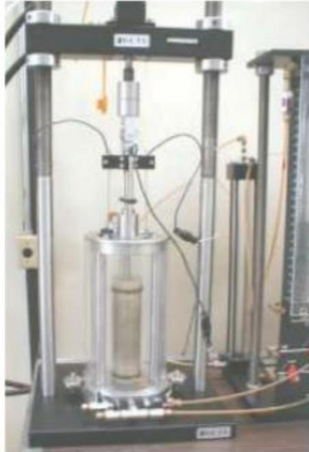
Figura 07: Equipo triaxial para determinar el módulo de resiliencia
