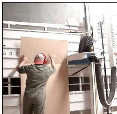
*Figura 15:* Pieza de madera cortada cae sobre operario.
