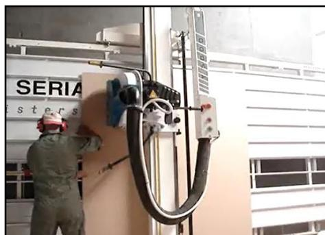
*Figura 12:* Corte eje vertical.
