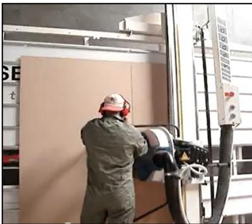
*Figura 13:* Corte eje vertical giro 90°
