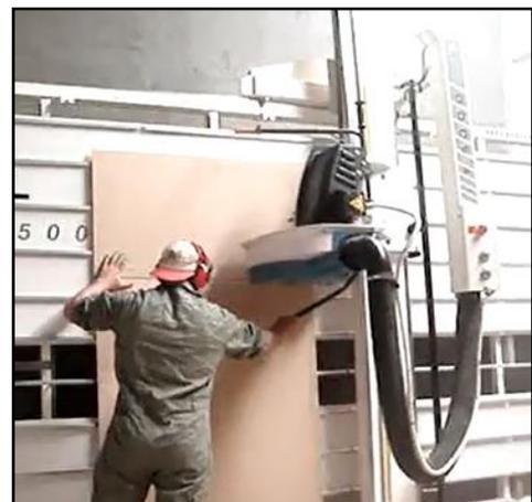
*Figura 14:* Corte eje horizontal.
