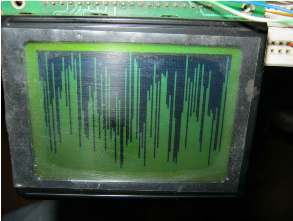
Figura 15. Prueba del GLCD en modo gráfico con líneas aleatorias.
