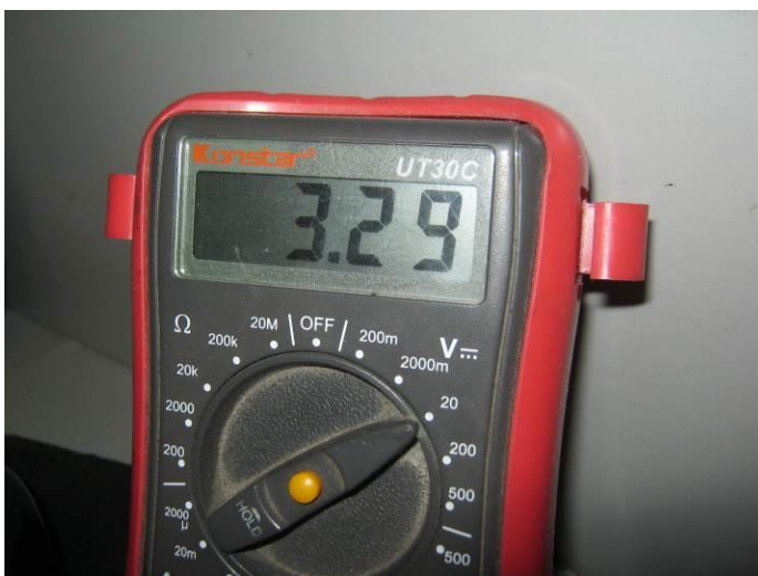
Figura 65. Medición a la salida del regulador de voltaje con alimentación DC
