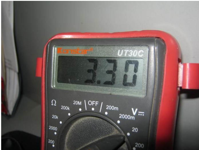
Figura 64. Medición a la salida del regulador de voltaje con alimentación AC
