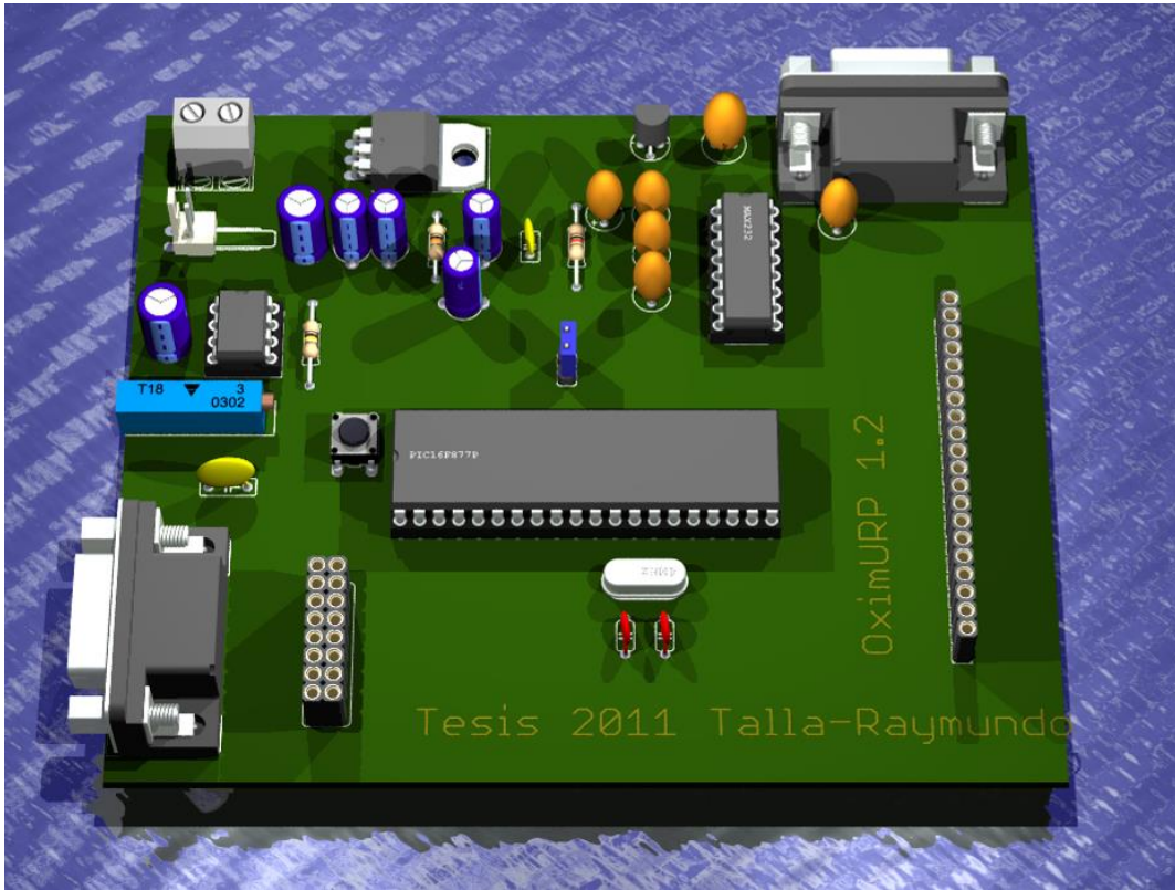
Figura 27. Prototipo de la Tarjeta de Circuito Impreso (PCB) creado con Eagle 3D.
