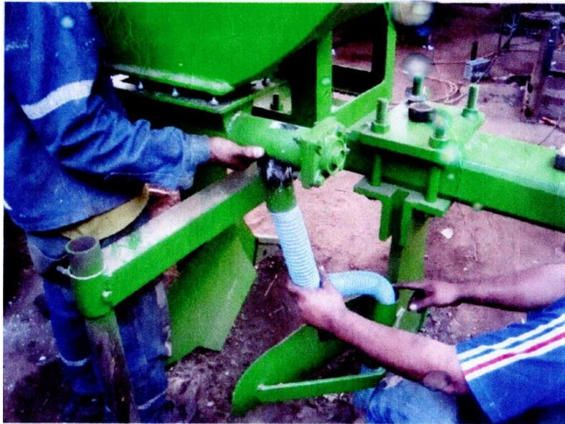
Figura 3.44 Colación de Mangueras de distribución
