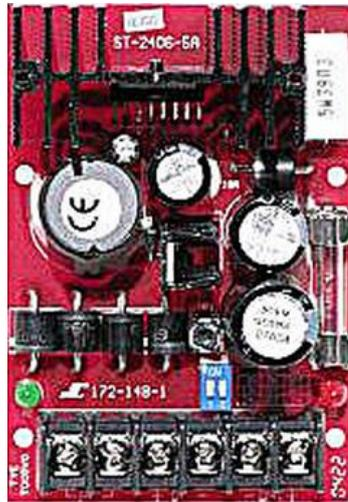
Figura 3.24 Cargador Enforcer ST-2406-5A
