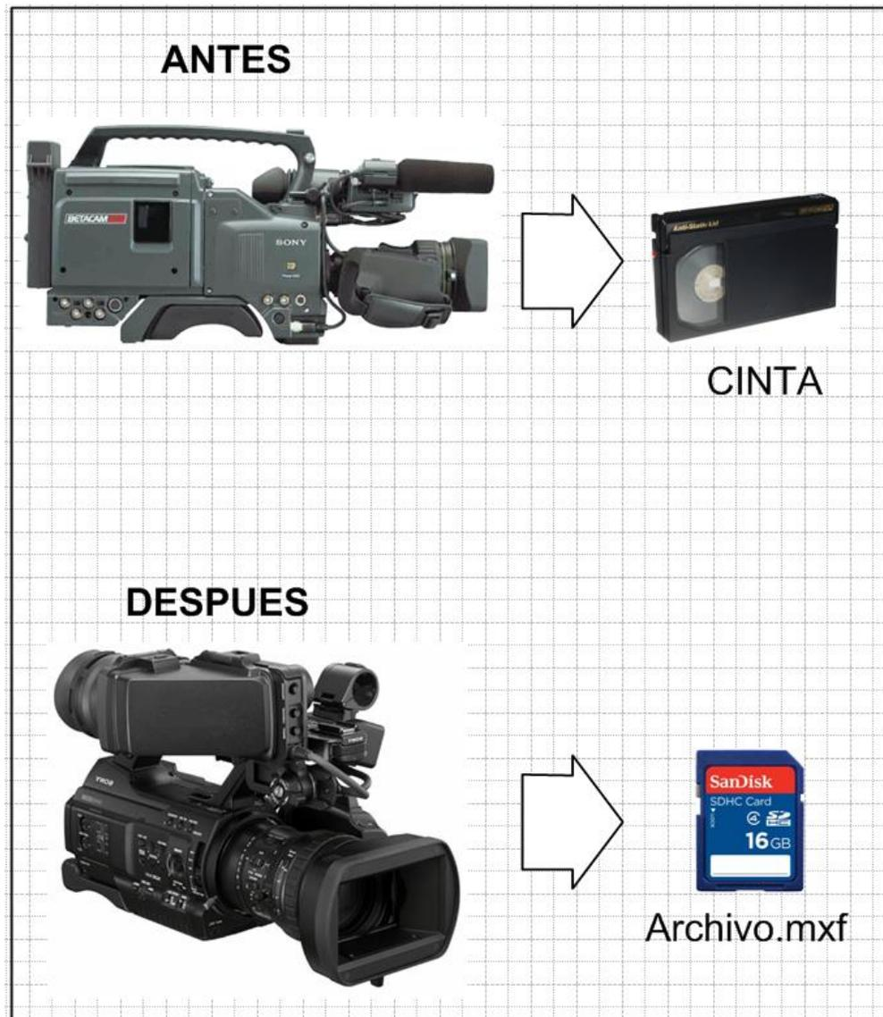
Figura 3: Adquisición en formato analógico vs Adquisición en formato Digital
