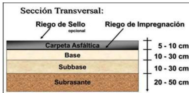
Figura N°4: Sección transversal de la estructura del pavimento
