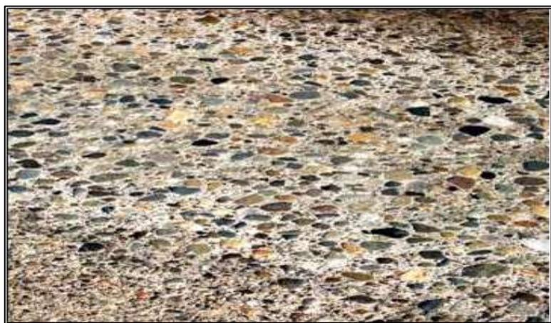
Figura N°25: Agregados pulidos.
