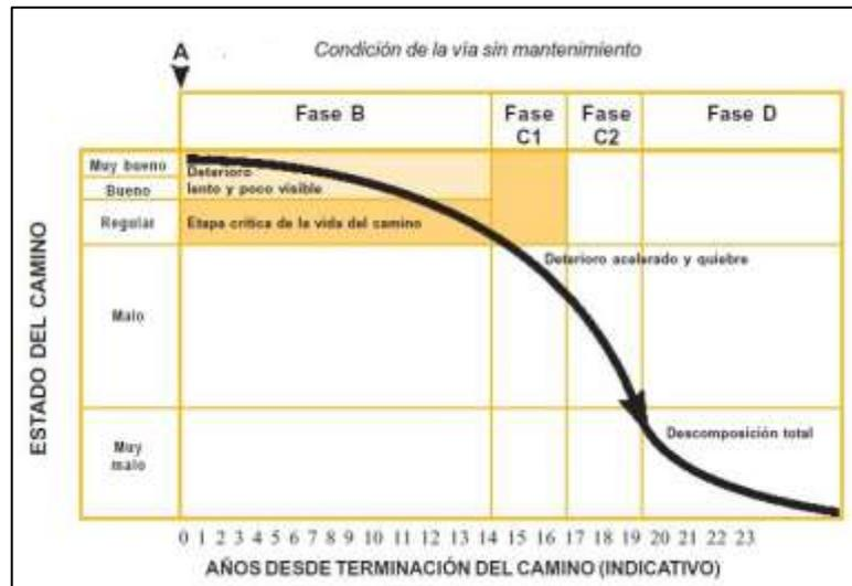
Figura N°6: Ciclo de vida de una vía sin mantenimiento
