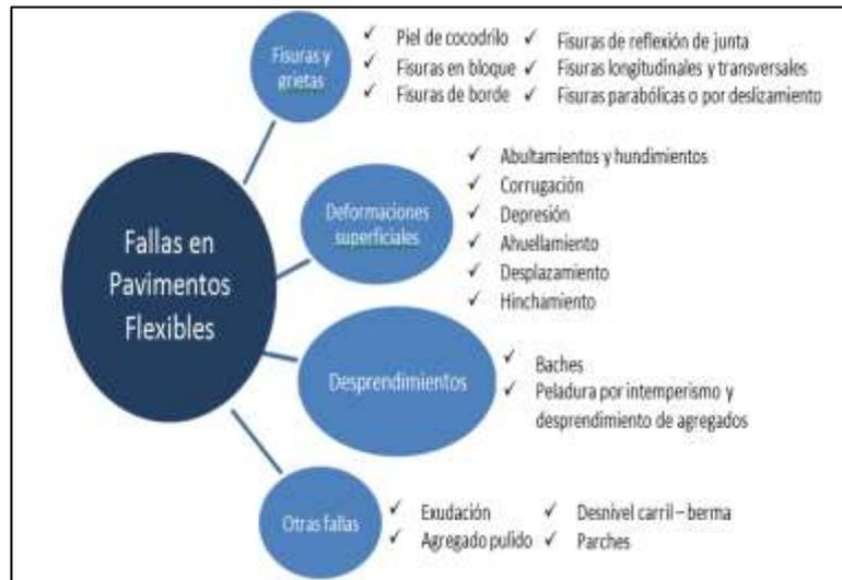
Figura N°8: Resumen de fallas en los pavimentos asfálticos
