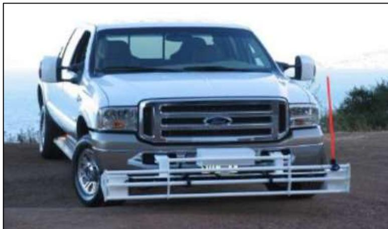
Figura N°31: Perfilómetro láser de la masa SSI
