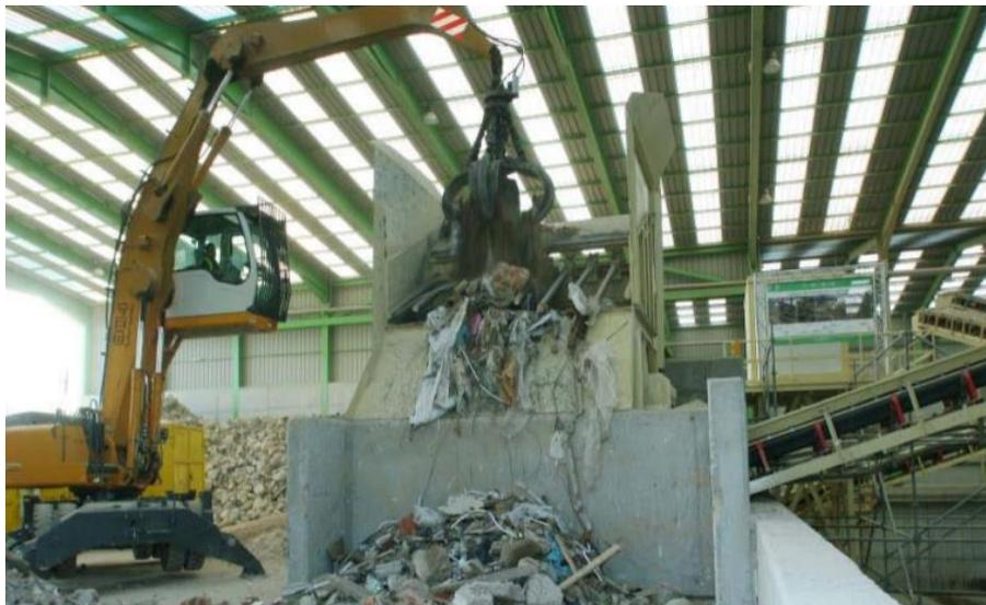
Figura 56: Alimentación en la planta de tratamiento
