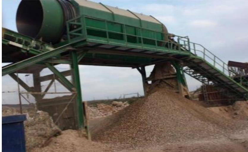
Figura 57: Clasificación mediante tromel
