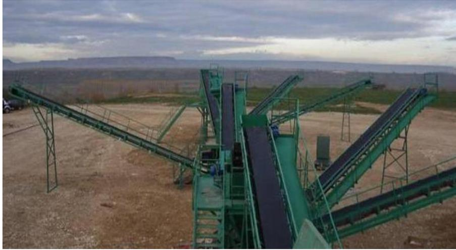
Figura 51: Cintas transportadoras de 14 m x 650 mm ancho
