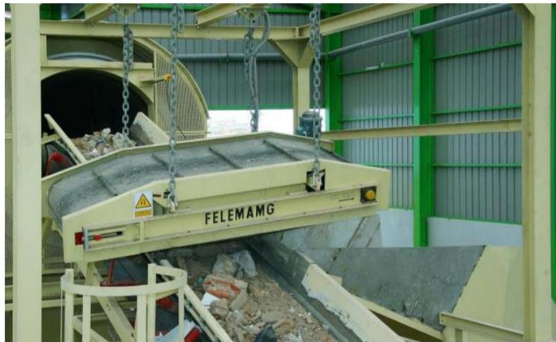
Figura 58: Separación de componentes férricos en la planta de tratamiento
