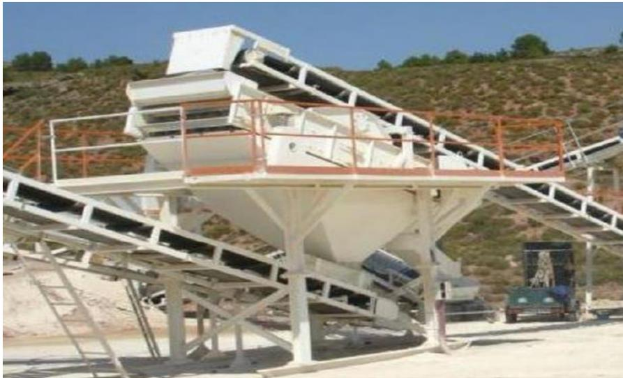
Figura 50: Criba Vibrante Modelo: Criba CV 38/15-3
