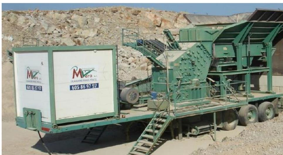
Figura 49: Tolva metálica de alimentación
