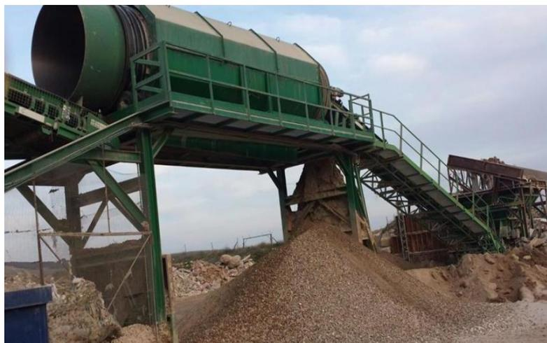
Figura 52: TROMEL DE 8m x 1.9 m con parrillas de clasificación de 8 mm
