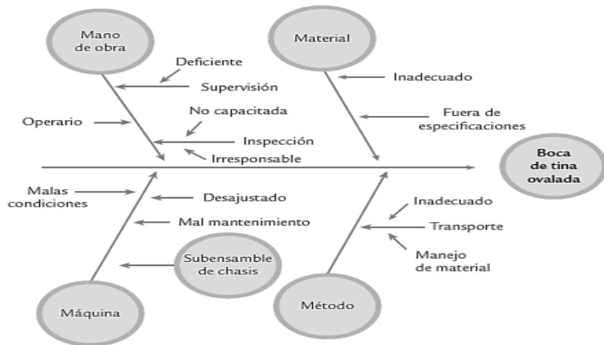
Figura 9: Ejemplo de Diagrama de Ishikawa con el método 6M
