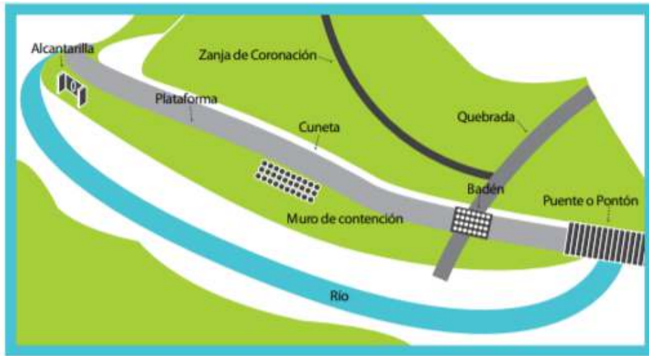
Figura 3. Principales elementos de un camino vecinal
