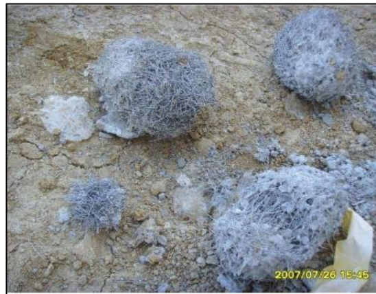
Figura N° 19: Formación de "erizos" o aglomeración de fibras
