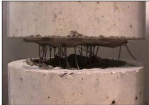
Figura N° 24: Rotura de probeta de concreto reforzado con fibras de acero
