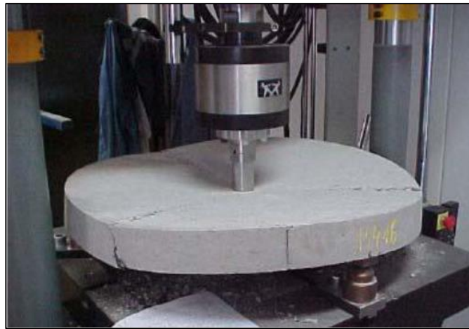
Figura N° 13: Configuración del ensayo de panel circular
