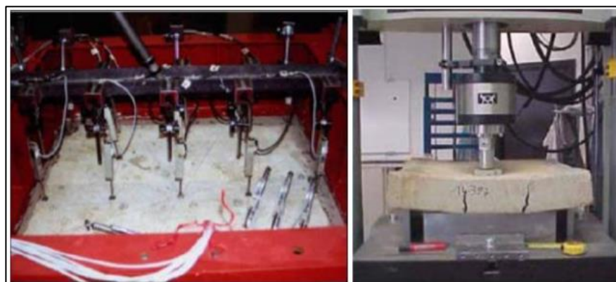
Figura N° 12: Diferentes configuraciones del ensayo de panel cuadrado
