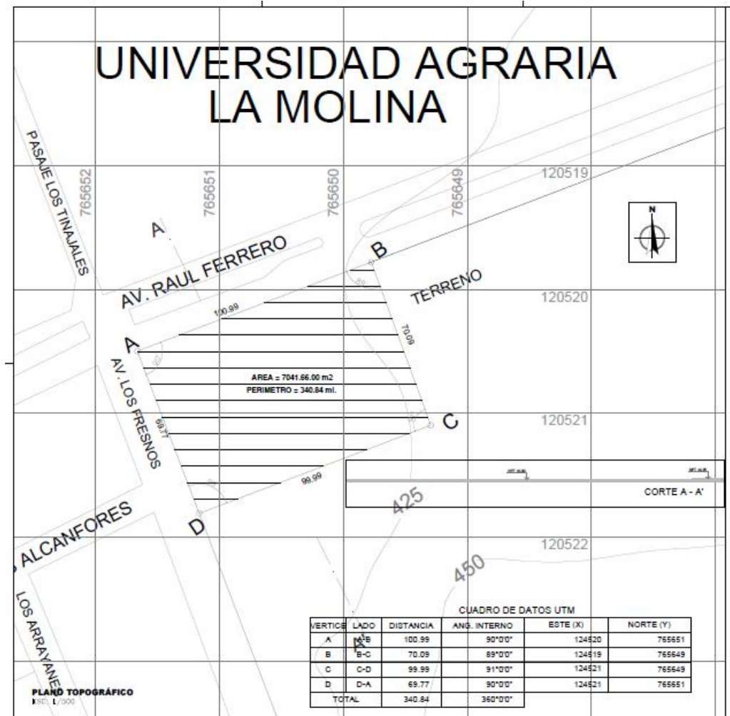
Figura 43. Plano topográfico. Fuente: Propia
