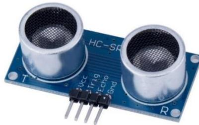
Figura N°24 Sensor Ultrasonido HC-SR04
