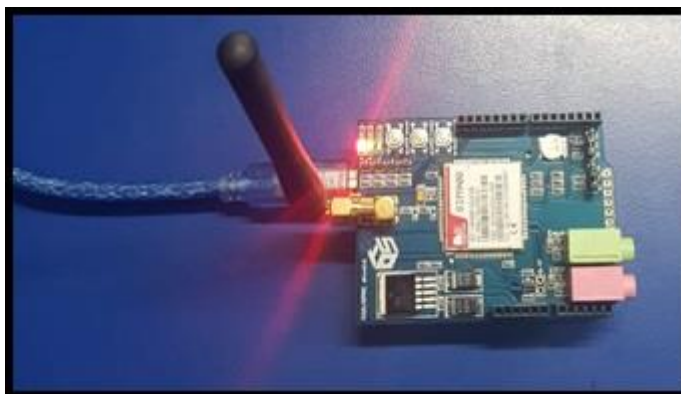
Figura 69: Encendido del módulo GSM SIM900 y operatividad
