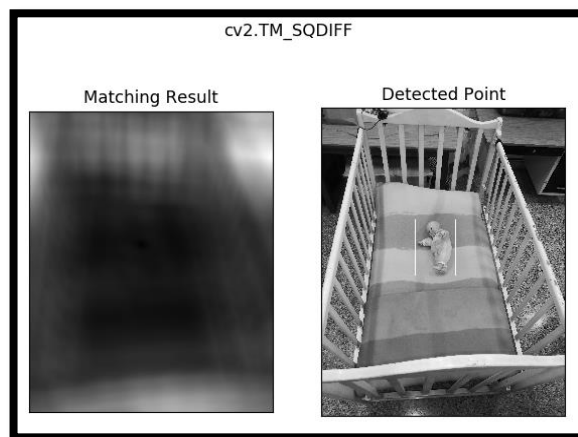
Figura N° 38: Resultado Ilustrado de función “cv2.TM_SQDIFF”
