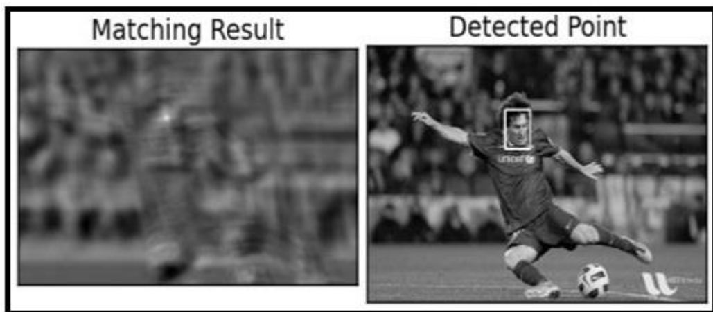
Figura 4: Ejemplo del uso de la función cv2.minMaxLoc()
