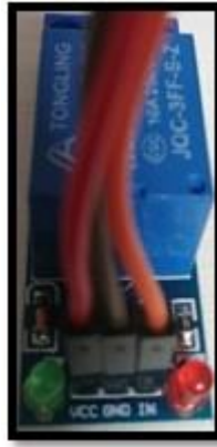
Figura 12: Alimentación y Control del Relé
