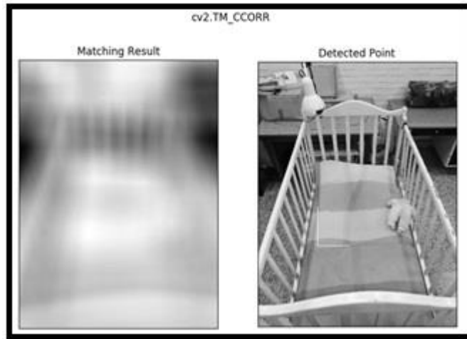
Figura 44: Resultado Ilustrado de función “cv2.TM_CCORR”
