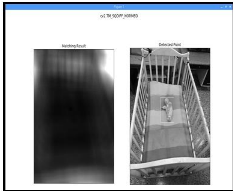
Figura 78: Resultado del procesamiento de imagen al detectarse posición 1
