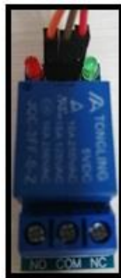
Figura 13: Borneras de Conexión del Relé
