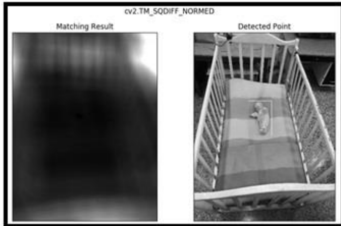
Figura 54: Resultado Ilustrado de función “cv2.TM_SQDIFF_NORMED” en posición “De lado”.
