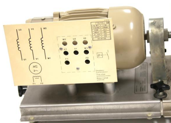
Figura 49. Además de las conexiones de la excitación, el motor dispone de las conexiones F1 y F2 para alimentar al rotor con corriente continua.
