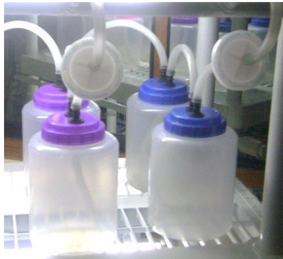
Figura 9. Ejemplo de un sistema de inmersión temporal con frascos Nalgene.
