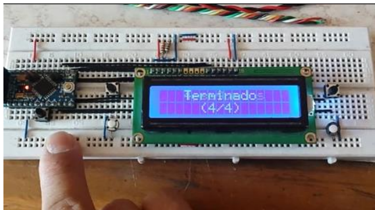
Figura 79. Circuito simulado y probado en el protoboard donde se observa el desarrollo de inmersión temporal mediante ciclos configurados para los cultivos.
