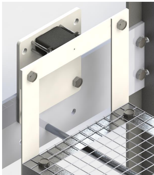
Figura 73. Mecanismo de transmisión servo-rejilla final.
