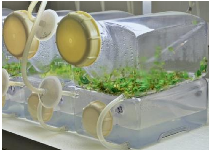
Figura 11. Ejemplo de un sistema de inmersión temporal SETIS.
