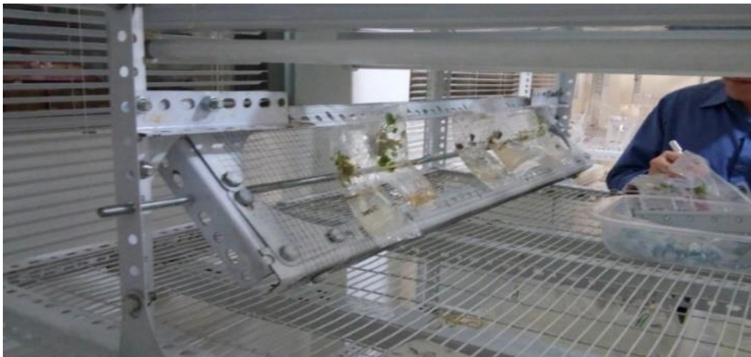
Figura 58. Imagen del sistema de inmersión temporal de rejilla manual.
