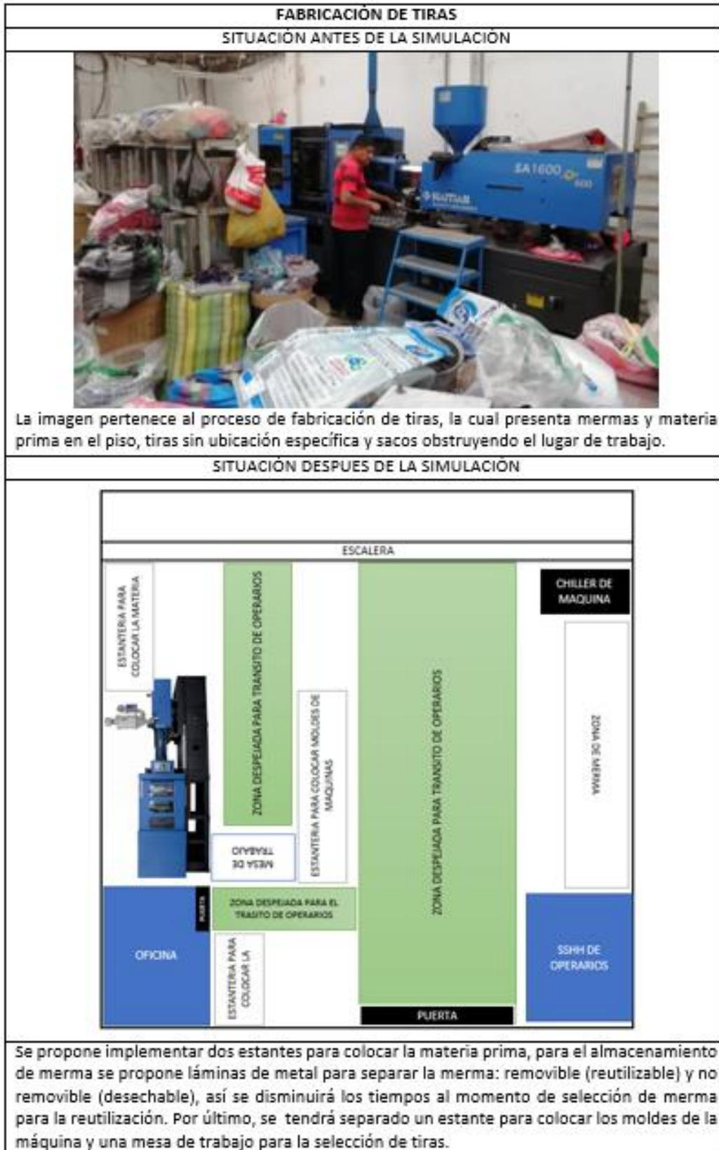
Figura 39: Layout mejorado del proceso de fabricación de tiras
