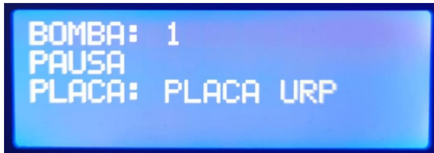
Figura 89: Mensaje del sistema smart fuel cuando la pistola está fuera de la bocatoma de combustible Fuente: Elaboración propia
