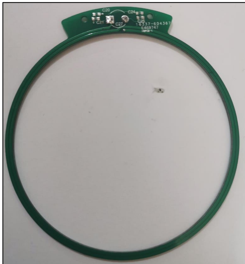
Figura 59: Tarjeta electrónica para el dispositivo tag pasivo Fuente: Elaboración propia
