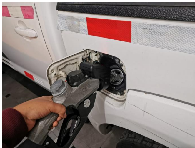
Figura 86: Colocación de la pistola de combustible en la bocatoma del tanque de combustible Fuente: Elaboración propia
