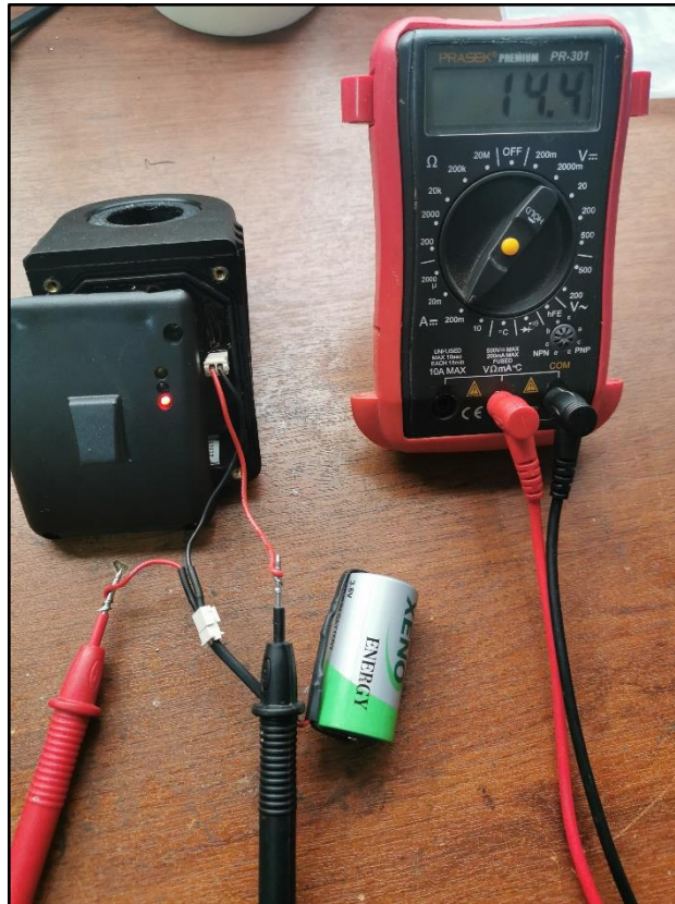
Figura 77: Medición de la corriente del sistema embebido principal encendido Fuente: Elaboración propia
