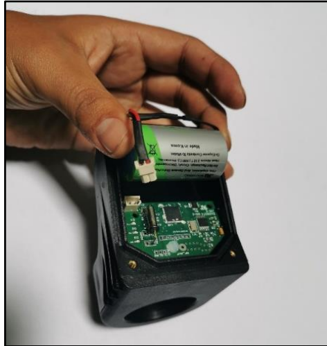
Figura 66: Ensamble de la pila en el chasis Fuente: Elaboración propia
