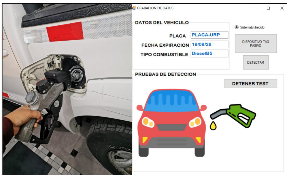
Figura 84: Detección del dispositivo tag pasivo con el sistema embebido principal Fuente: Elaboración propia
