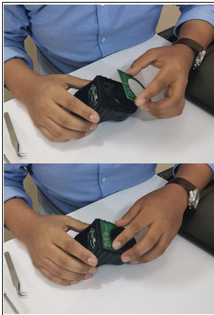
Figura 62: Instalación de la antena RFID en el chasis Fuente: Elaboración propia
