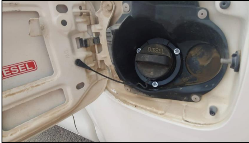
Figura 75: Instalación del dispositivo tag pasivo en el vehículo. Fuente: Elaboración propia
