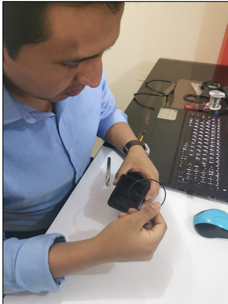
Figura 50: Instalación del o-ring en el chasis. Fuente: Elaboración propia
