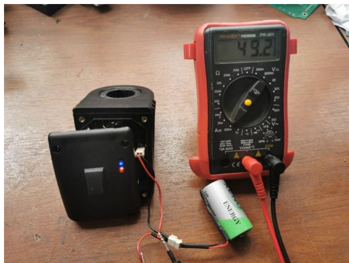
Figura 79: Medición de la corriente transmitiendo y recibiendo información inalámbrica Fuente: Elaboración propia
