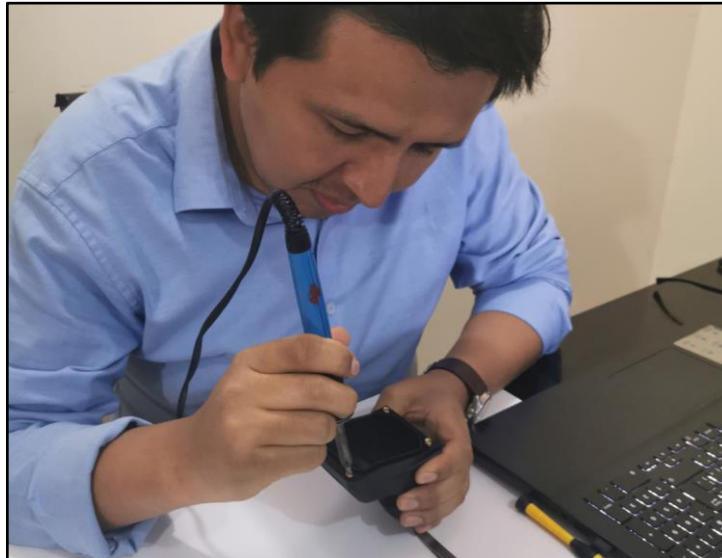
Figura 51: Instalación de los insertos para plásticos M3 Fuente: Elaboración propia
