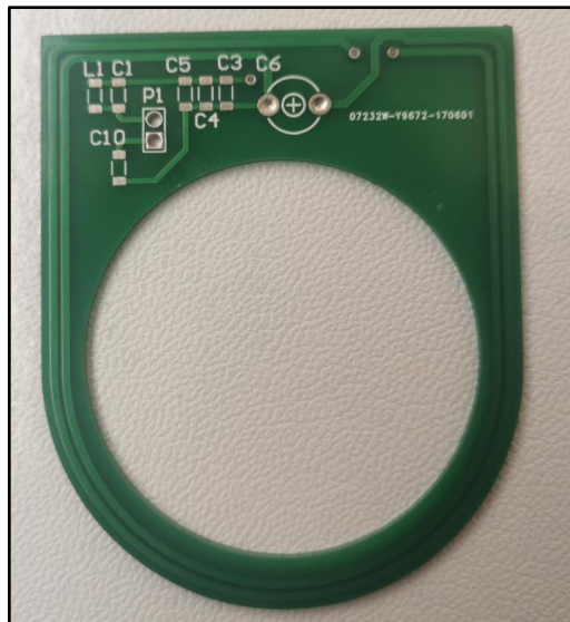
Figura 55: Tarjeta electrónica de la antena RFID Fuente: Elaboración propia
