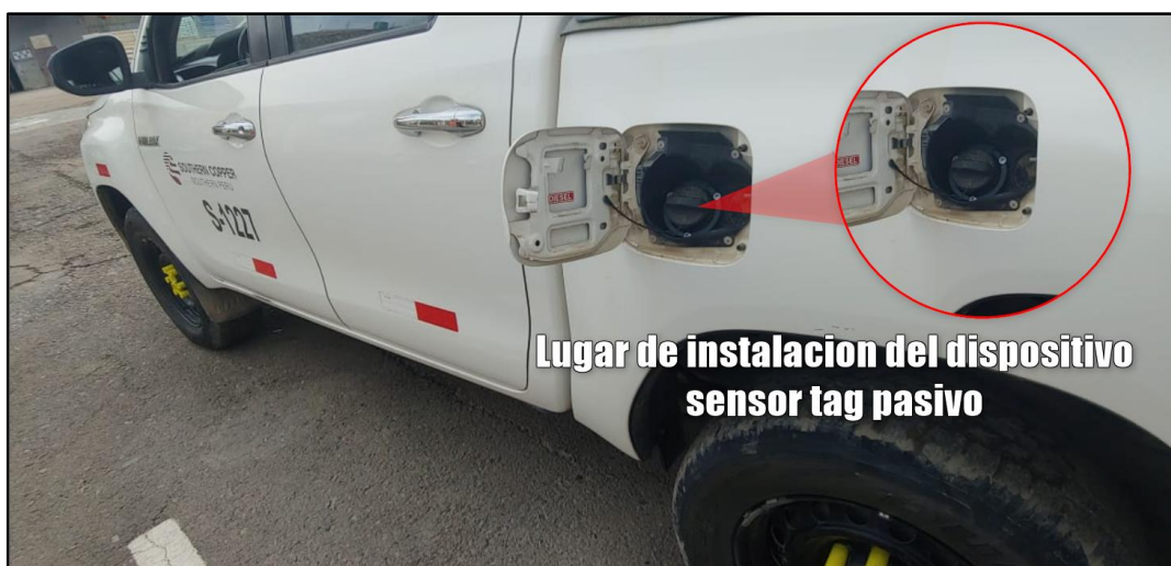
Figura 11: Lugar de instalación del dispositivo sensor tag pasivo Fuente: Elaboración propia
