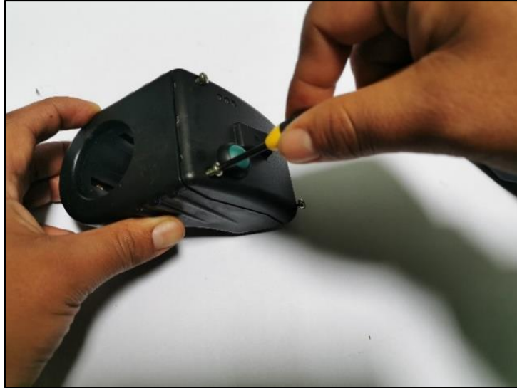
Figura 68: Colocación de la tapa superior del chasis Fuente: Elaboración propia
