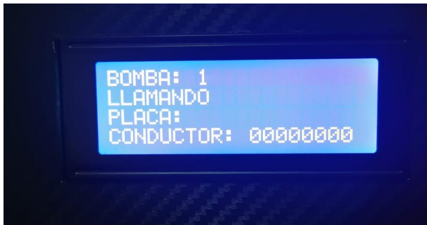
Figura 87: Mensaje del sistema smart fuel en el inicio del proceso de abastecimiento. Fuente: Elaboración propia
