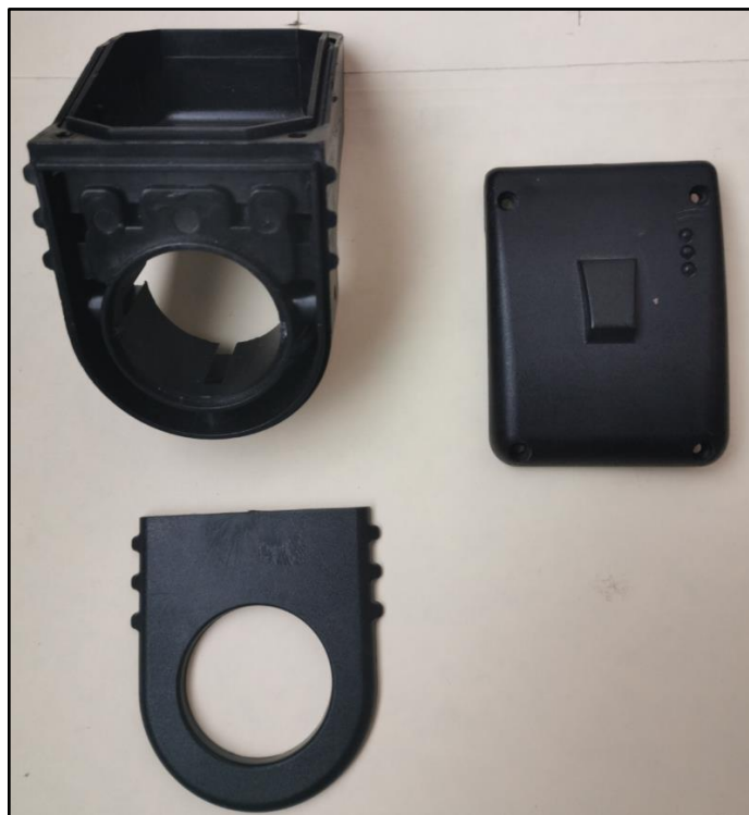
Figura 49: Partes del chasis del sistema embebido principal Fuente: Elaboración propia
