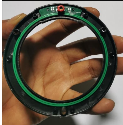
Figura 70: Ensamble de la tarjeta electrónica del dispositivo tag pasivo Fuente: Elaboración propia
