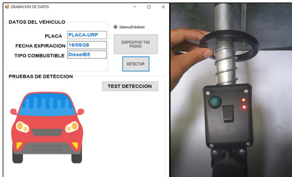
Figura 80: Prueba de lectura o escritura de información por RFID Fuente: Elaboración propia
