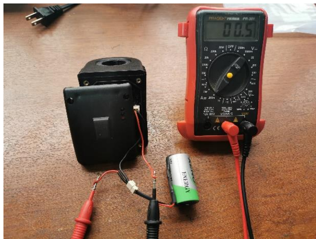
Figura 76: Medición de la corriente apagada. Fuente: Elaboración propia
