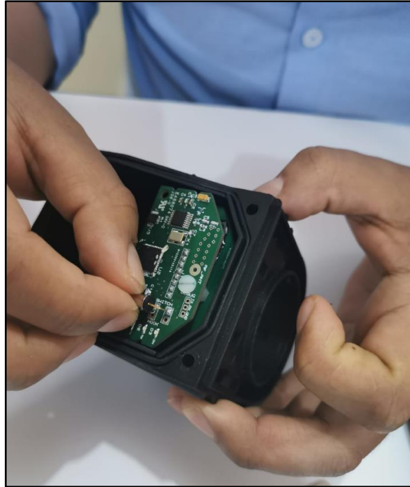
Figura 64: Soldadura de la antena RFID en las tarjetas electrónicas. Fuente: Elaboración propia
