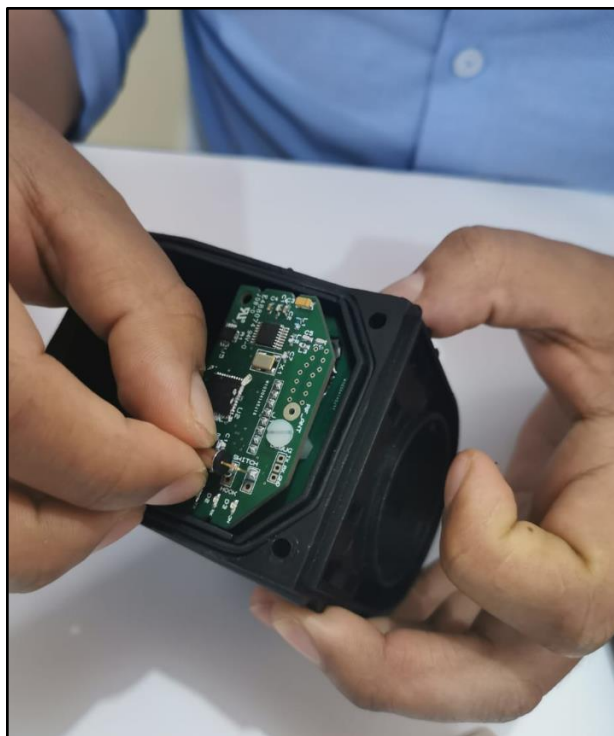
Figura 65: Ensamble de las tarjetas electrónicas en el chasis Fuente: Elaboración propia
