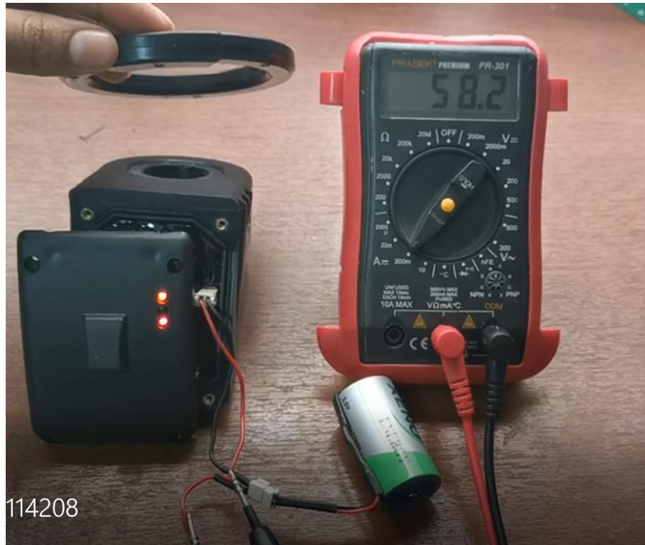
Figura 81: Medición de la corriente en lectura del dispositivo tag pasivo Fuente: Elaboración propia
