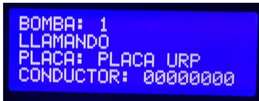
Figura 88: Mensaje de sistema smart fuel cuando recibe la información de la placa del vehículo Fuente: Elaboración propia
