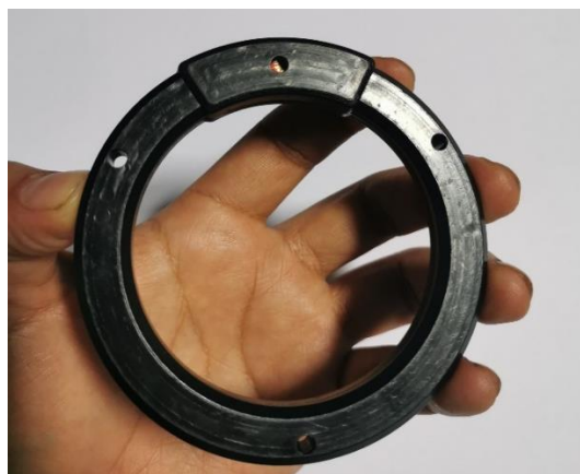
Figura 71: Sellado del chasis del dispositivo tag pasivo Fuente: Elaboración propia
