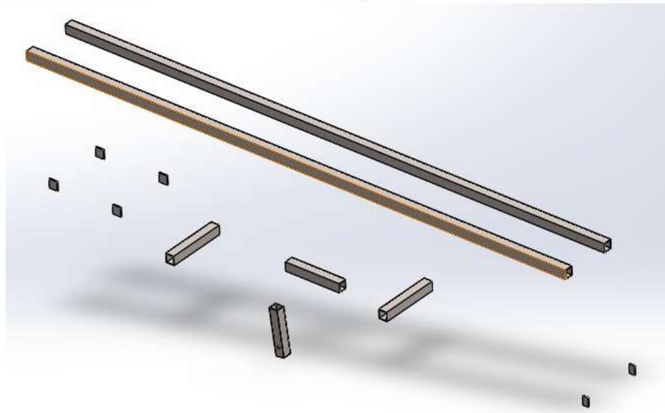
Figura 25: Explosión de los componentes del riel. Fuente: Elaboración propia.
