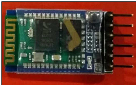
Figura 43 : Módulo de comunicación Bluetooth (HC-05) Fuente : Elaboración propia
