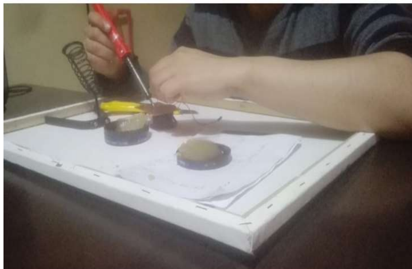
Figura 54: Soldado de los componentes en la placa de baquelita. Fuente : Elaboración propia
