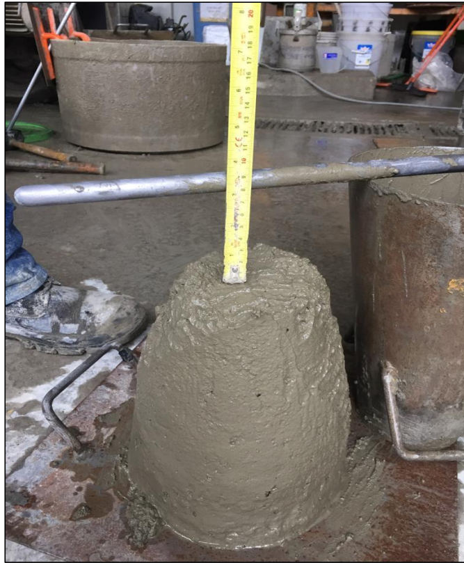
Figura 22: Prueba de slump de mezcla
