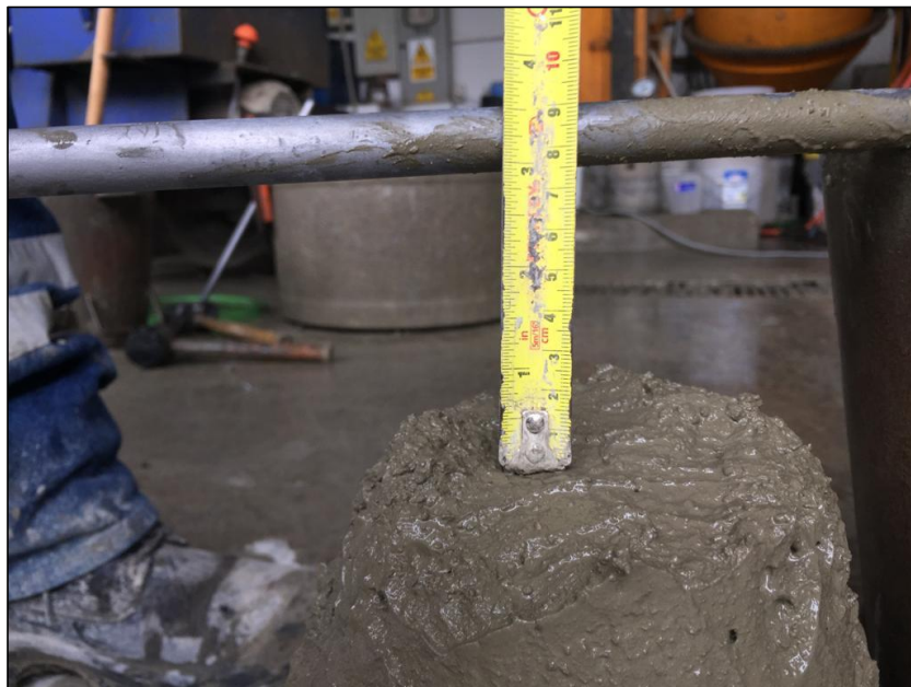
Figura 23: Asentamiento de la mezcla
