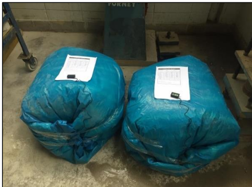
Figura 37: Cajas térmicas con fibra de vidrio Fuente: Elaboración propia
