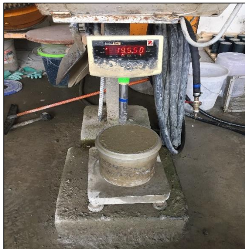
Figura 8: Pesaje de concreto en estado fresco Fuente: Elaboración propia
