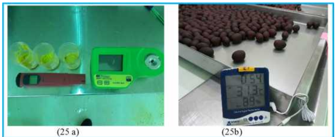
Figura 25: Verificación del pH, °Brix de la fruta y control de humedad relativa y temperatura del ambiente de trabajo. Elaboración propia
