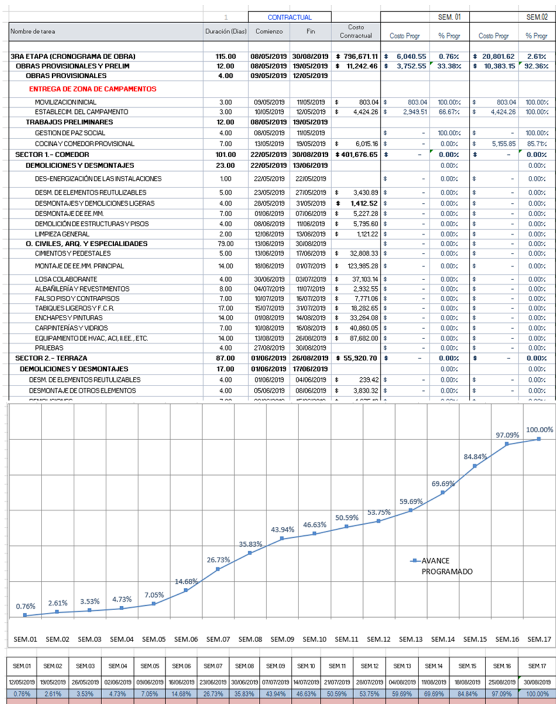
Figura N°34: Línea base inicial: Curva S del proyecto
