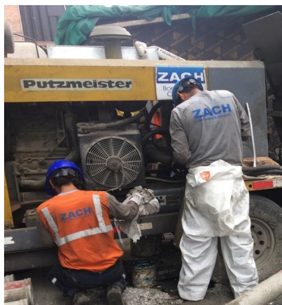
Figura 26 Mantenimiento de la bomba estacionaria Fuente: Propia
