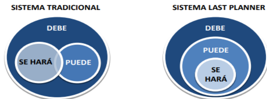
Figura 7 Comparación entre el Sistema Tradicional y sistema Last Planner Fuente: Guía para la Implementación, Alarcón (2008)
