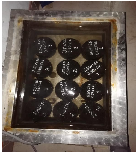
Fotografía 05, Ciclo de inmersión en agua a 60 °C, 24 horas.
