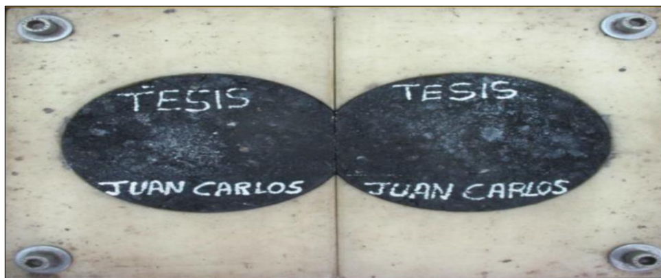
Figura 20. Briquetas preparadas antes de ser ensayadas.
