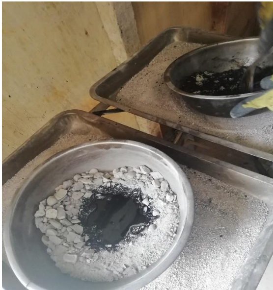
Fotografía 01, Mezcla de muestras calientes antes de compactar.
