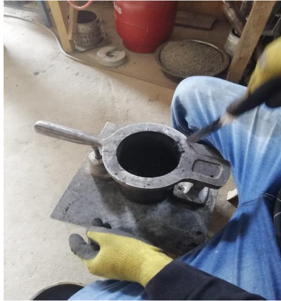
Fotografía 02, Compactado de la mezcla.
