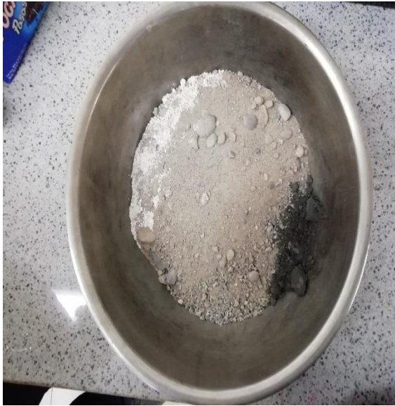
Fotografía 07, Preparado y calentamiento de los agregados.
