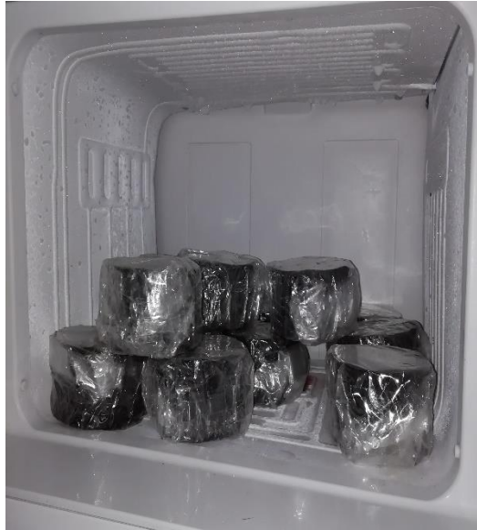
Fotografía 04, Ciclo de congelamiento de briquetas a -18 °C, 16 horas.
