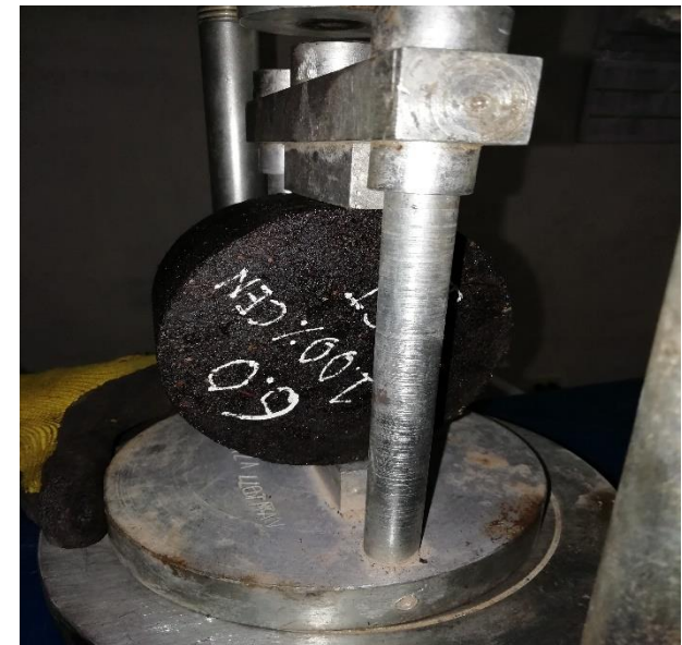
Fotografía 03, Rotura de briquetas, prensa Marshall.
