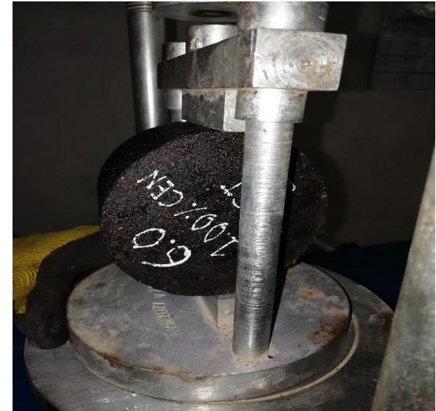
Fotografía 06, Rotura de briquetas, prensa Marshall.
