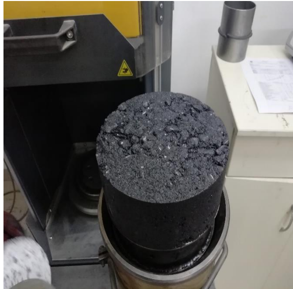
Fotografía 08, Muestra compactada en el compactador superpave.
