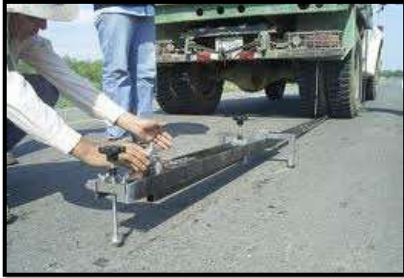
Figura 6: Medición de deflexión con Viga Benkelman Fuente: Propia
