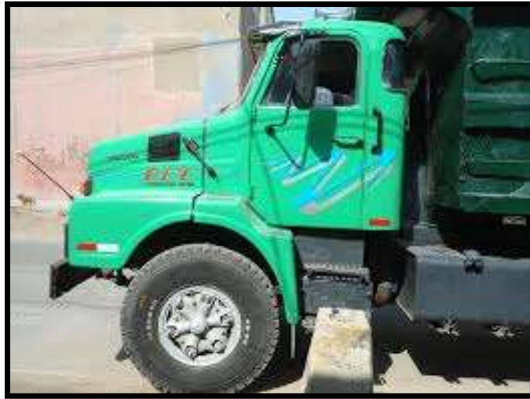
Figura 14: Volquete Inoperativo por aro dañado Fuente: Propia
