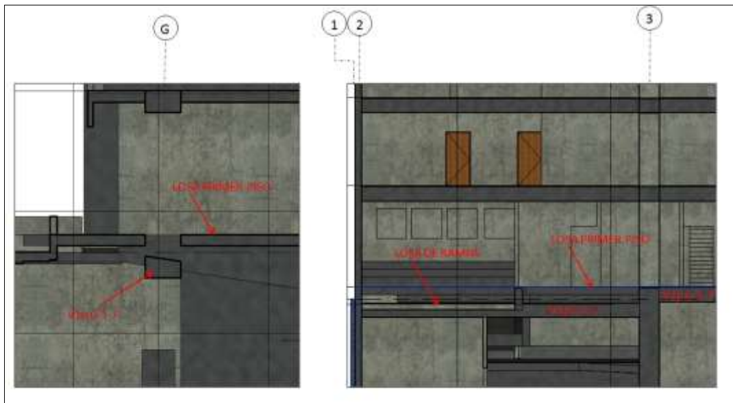
Figura N° 3.18: Viga por debajo del nivel de losa en sótanos.
