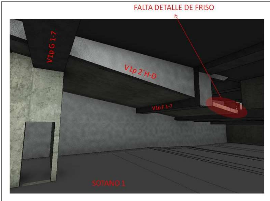
Figura N° 4.10: Ausencia de viga en frizo de rampa en sótano. (FUENTE: Constructora Arcadia SAC)
