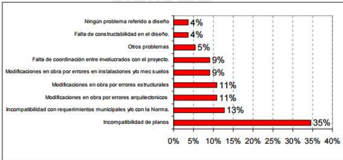
Figura N° 1.03: Problemas ocurridos en obra debido a un mal diseño.
