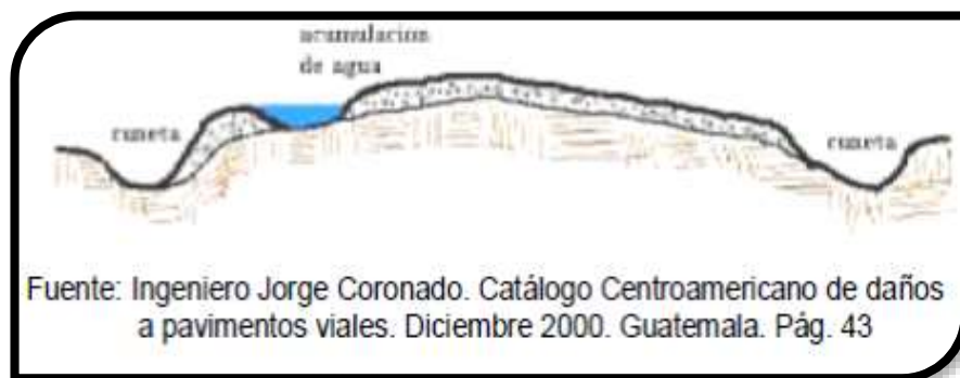
FIGURA N° 2 SECCION TRANSVERSAL IMPROPIA
