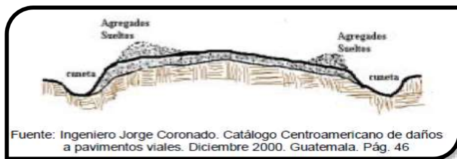
FIGURA N° 8 PERDIDA DE AGREGADOS
