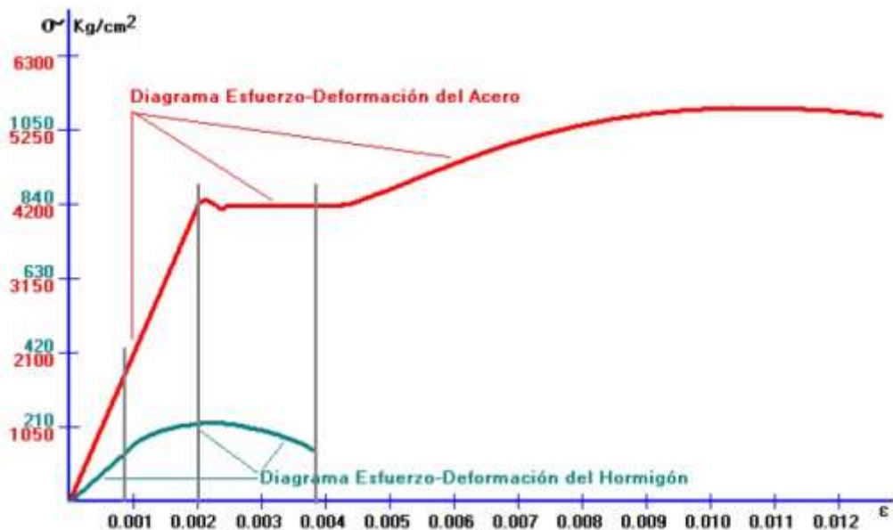
Figura 3. Diagramas Esfuerzo-Deformación del concreto y acero a compresión
