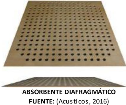
También es conocido como absorbente de membrana. Consiste en una membrana rígida sobre un bastidor que la separa de la pared, creando una cavidad de aire. Cada absorbente diafragmático tiene una frecuencia fundamental de oscilación (y de absorción) determinada por el peso y flexibilidad del material de la membrana y la distancia de la cavidad de aire.
