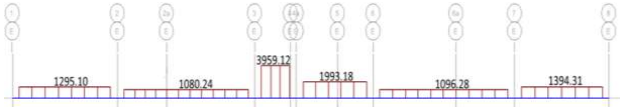
Figura 68. Diagrama de fuerza cortante por carga de sismo en Y con E.030-2014
