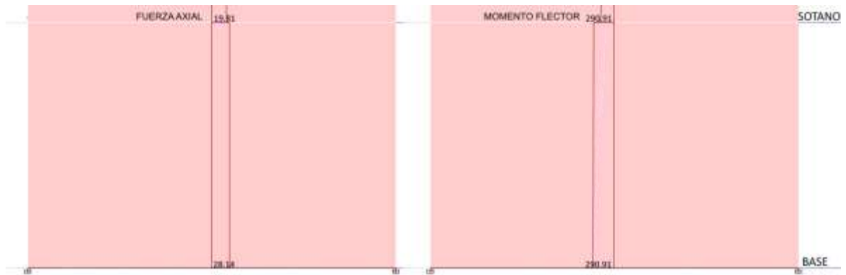
Figura 105. Diagramas de fuerza de compresión y momento flector por carga de sismo en Y (E.030-2003)
