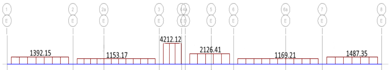
Figura 69. Diagrama de fuerza cortante por carga de sismo en Y con E.030-2003
