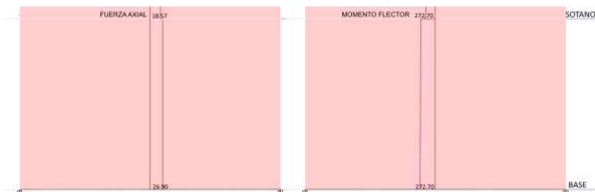
Figura 104. Diagramas de fuerza de compresión y momento flector por carga de sismo en Y (E.030-2014)
