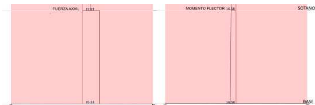
Figura 103. Diagramas de fuerza de compresión y momento flector por carga de sismo en X (E.030-2003)
