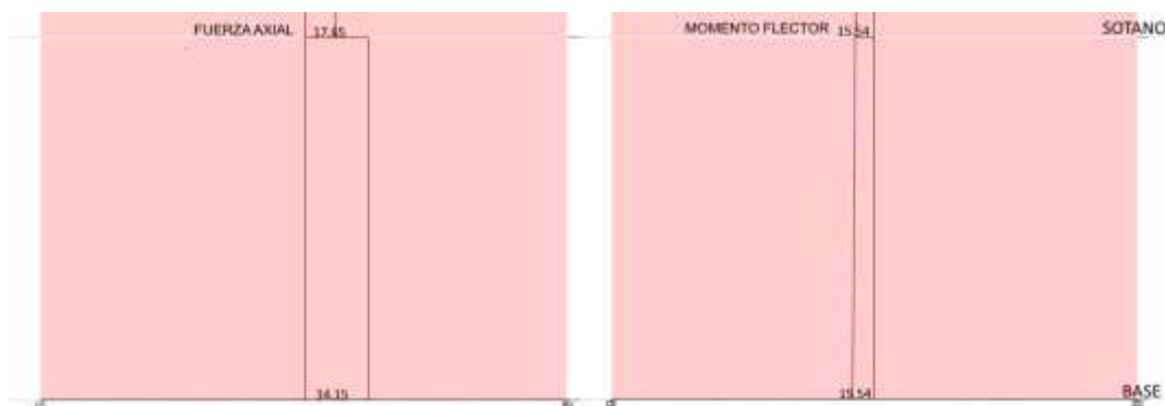
Figura 102. Diagramas de fuerza de compresión y momento flector por carga de sismo en X (E.030-2014)
