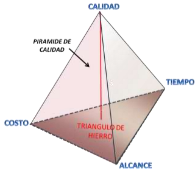
Figura 2- 4 Triángulo de hierro y Pirámide de la Calidad en Proyectos
