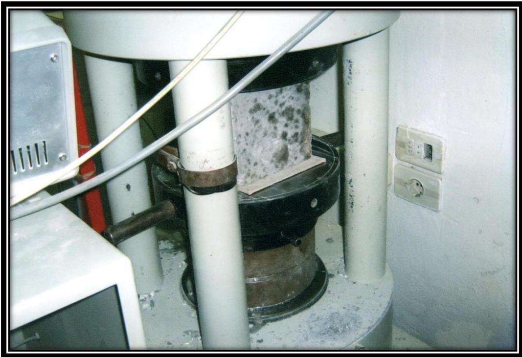
Foto 33: Rotura de la briqueta de concreto.
