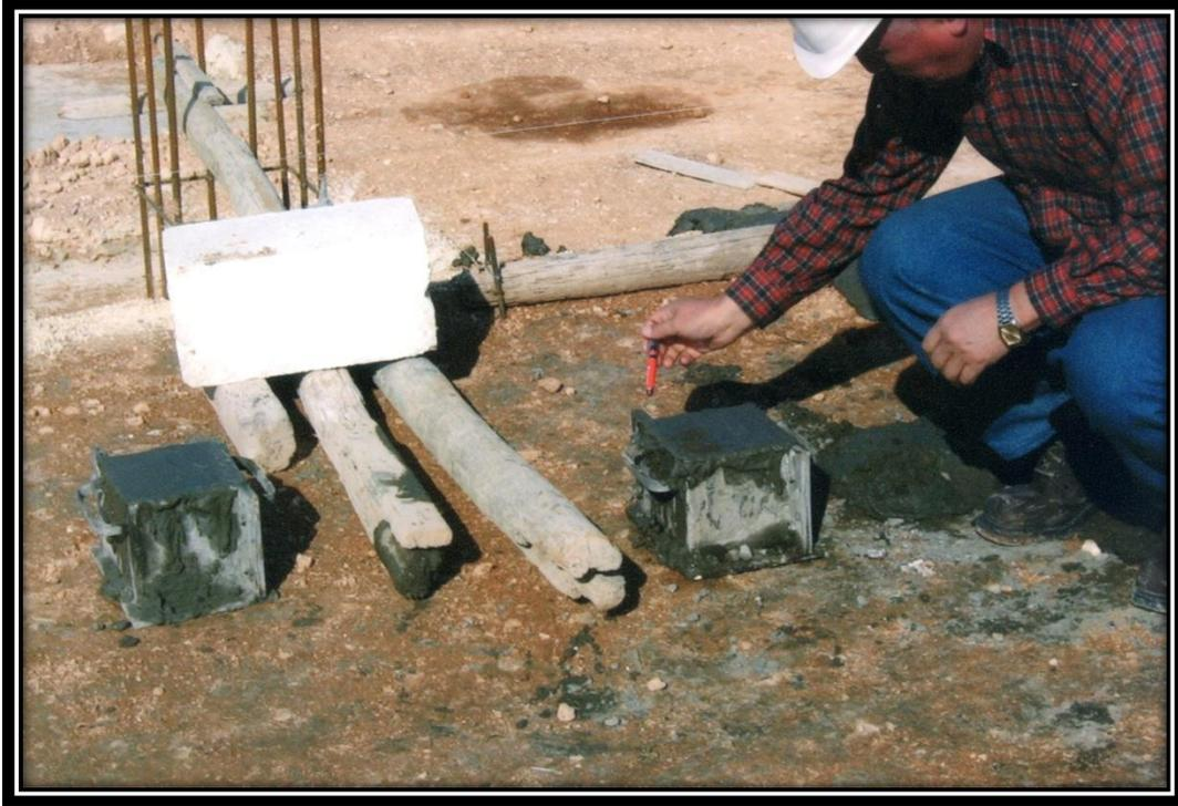
Foto 31: Extracción, por la Supervisión, de la muestra de concreto.
