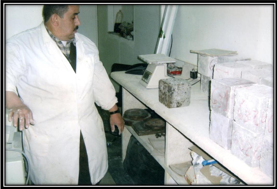
Foto 32: Briqueta típica del concreto para control de calidad. Ensayo de compresión.
