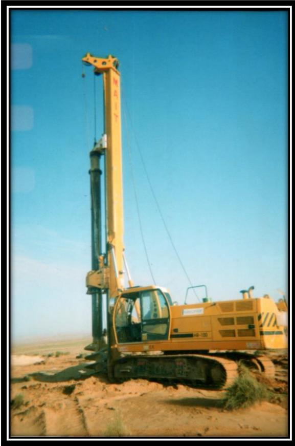
Foto 7: Movimiento de tierra masiva. Equipo de excavación de roca tipo caliche compacto.
