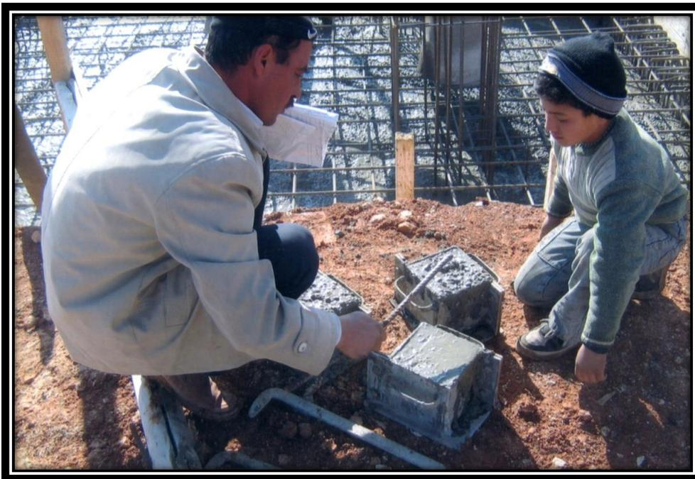
Foto 30: Extracción de muestras de concreto 175 y 210 kg/cm<sup>2</sup> para ser enviado a laboratorio. Dentro del marco legal y enmarcado en la tradición familiar es habitual que los trabajadores calificados enseñen a sus hijos, en etapas de vacaciones escolares, la técnica y procedimientos de la construcción civil.
