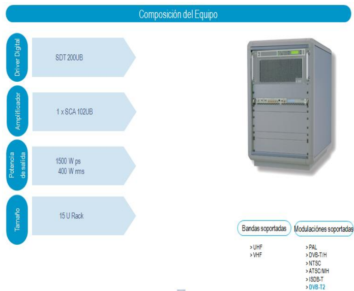
Figura 28 Composición típica de un transmisor con tecnología MAGNUM [5]
