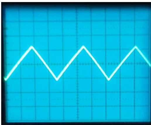
Figura 5.9: Respuesta real del generador de onda triangular a 8 kHz.
