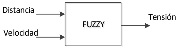
Figura 4.19: Definición de variables entradas – salida para el controlador Fuzzy.
