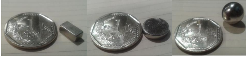
Figura 2.23: Masas magnéticas a usar en el sistema de levitación.
