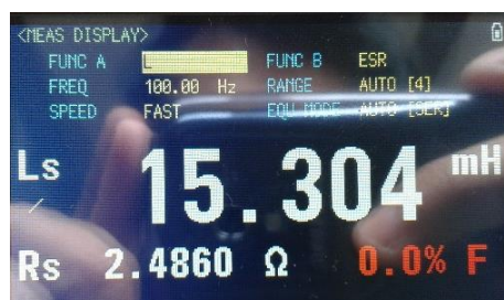
Figura 2.14: Toma de medidas de inductancia a 100Hz y 10KHz de la bobina, de arriba para abajo.
