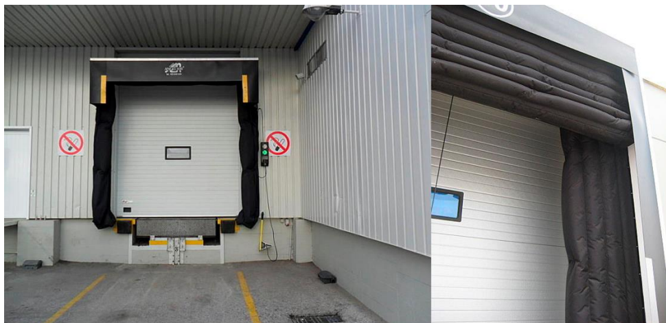
Ilustración 39. Imagen referencial de sellos inflables en puertas de despacho.
