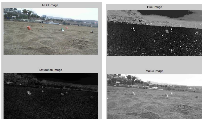
Figura: 38 Imagen Original, seguidamente Imagen Hue, Imagen Saturation e Imagen Value de imagen RGB original
