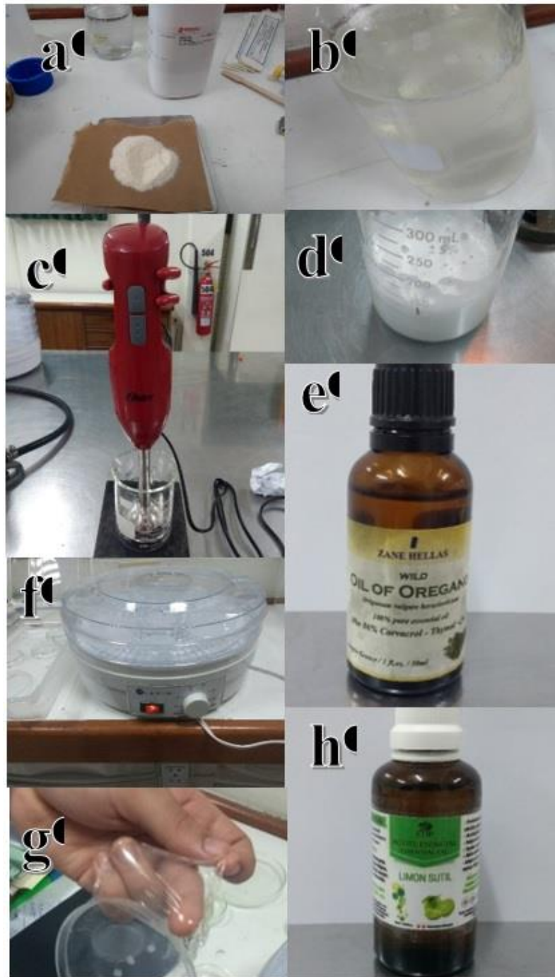
Fig. 6 Preparación de la biopelícula de quitosano y aceites esenciales de Citrus aurantifolia y Origanum vulgare .
