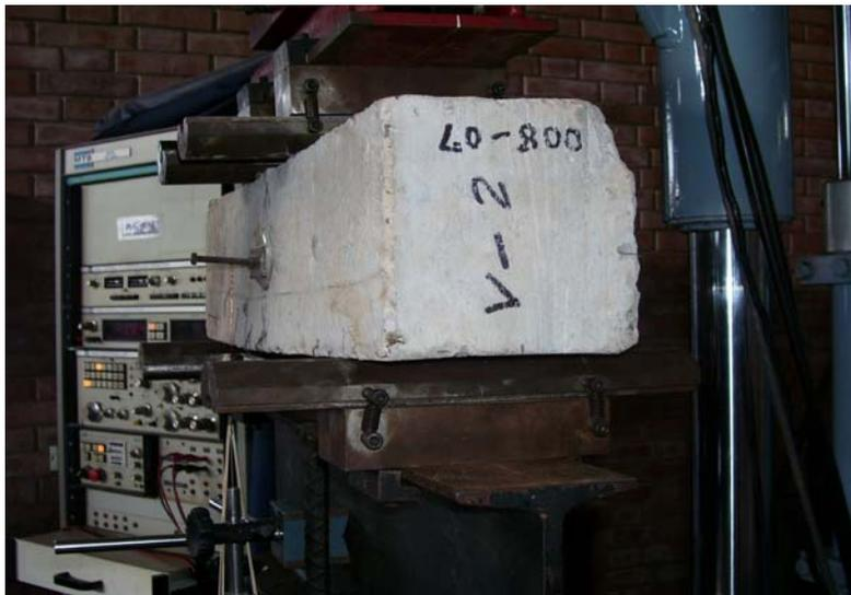
Se observa la Viga V-02 realizando el ensayo
