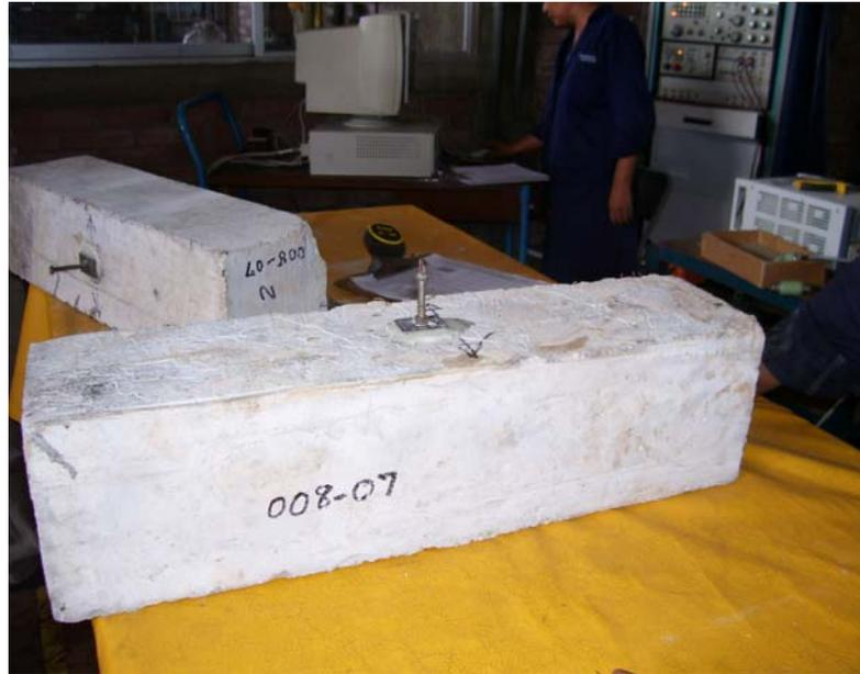
Se puede observar las vigas ya preparadas para ser ensayadas.
