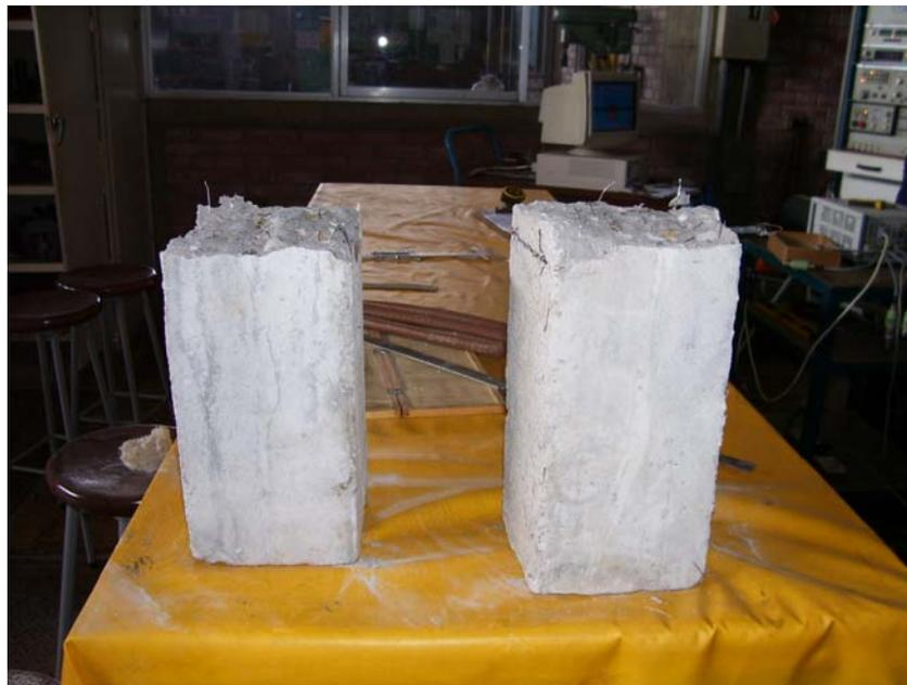
Se observa la Viga V -02 fisurada, se rompió, ya que no había presencia de fibras, para que se queda tensionada.
