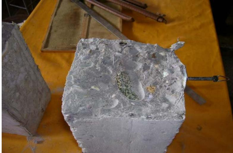
Se observa que en la Viga V -02 no hubo homogeneidad en la mezcla, ya que como se puede apreciar no hay presencia de fibra Wirand FF1
