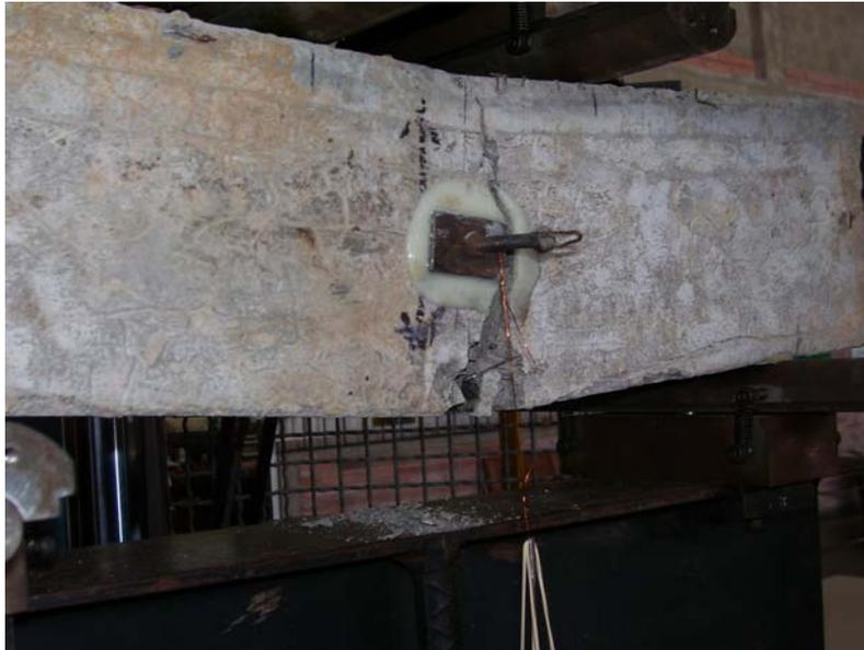
Se observa la Viga V- 02 ensayada, ya con fisuración
