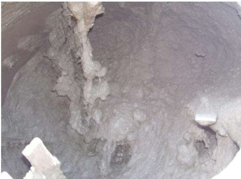
Se puede observar la homogeneidad de la fibra e el mezclado.
