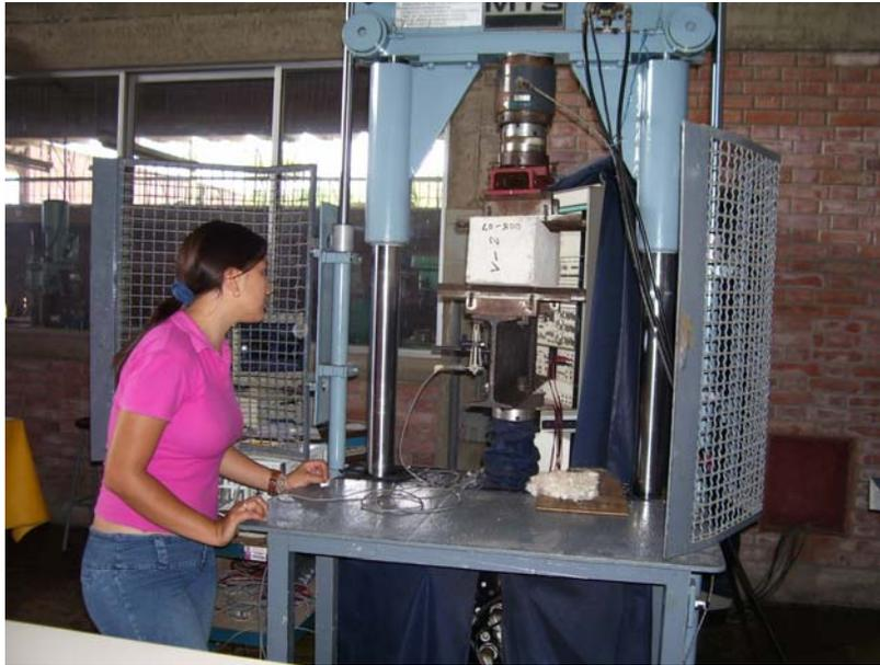
Se observa en la máquina la Viga V- 02 para ser ensayada
