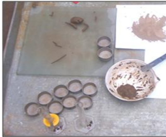
Preparación de la muestra para límite plástico
