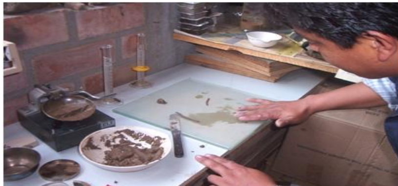
Formación de la muestra cilíndrica de límite plástico
