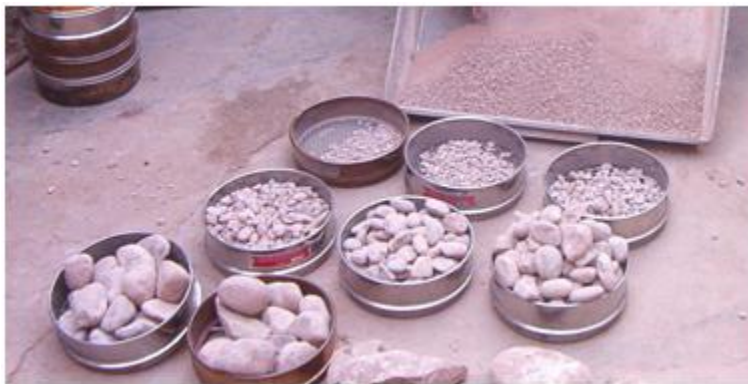
Grava retenida por los distintos tamices desde el tamaño mayor hasta la malla N° 4
