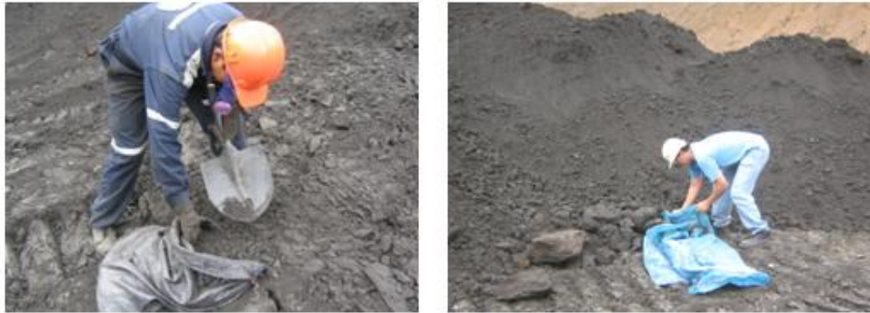
Toma de muestras representativas del material de relave drenado
