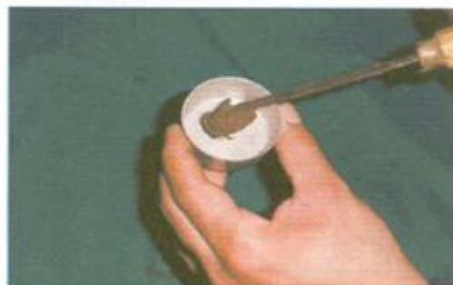
Obtención de la muestra para ser llevado al horno.
