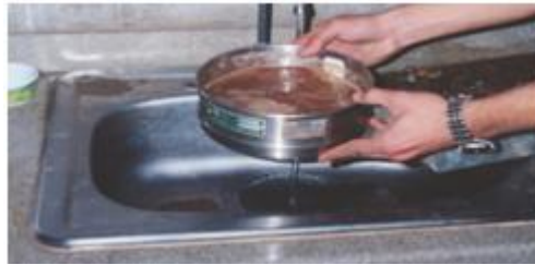
Lavado del agregado fino
