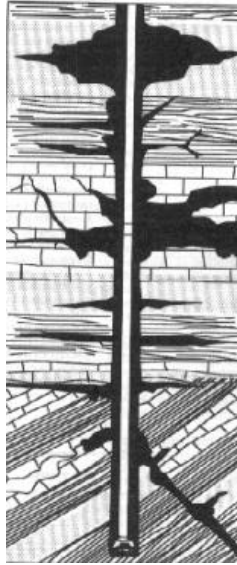
Figura 3-11 Secciones de pérdidas de circulación
