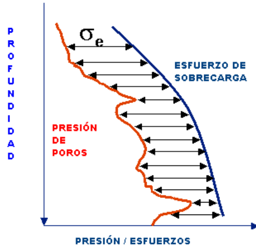
Figura 3-1 Distribución de esfuerzos en una roca porosa (Schlumberger, 2005)
