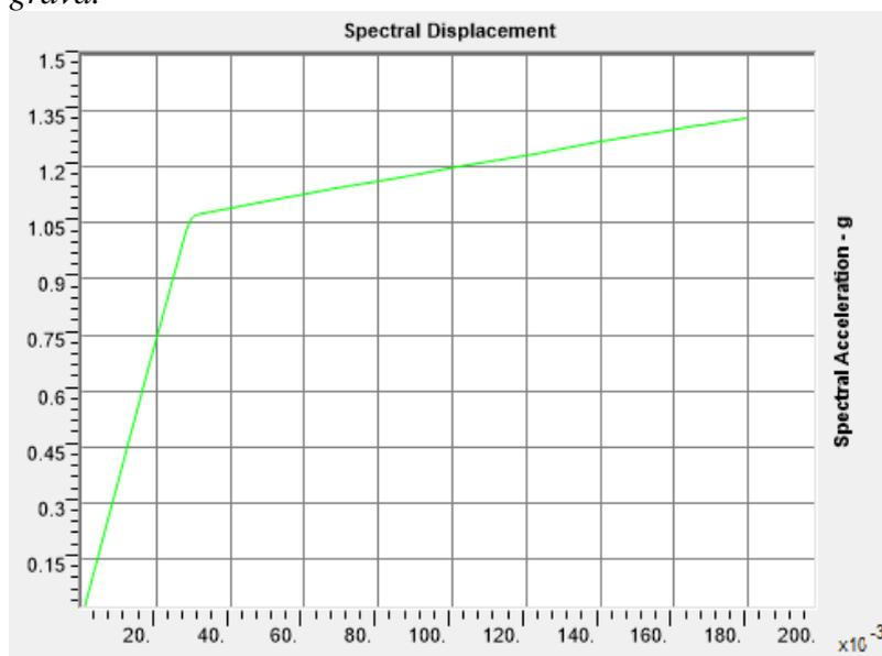
*Nota:* Valores de curva capacidad convertida a un sistema espectral con suelo flexible con columnas de grava, donde el eje vertical representa la aceleración espectral ( $S_a$ ) en g, mientras el eje horizontal representa el desplazamiento espectral ( $S_d$ ) en m.
