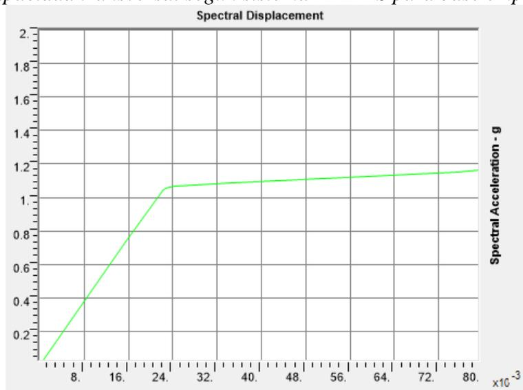
*Nota:* Valores de curva capacidad convertida a un sistema espectral con base empotrada, donde el eje vertical representa la aceleración espectral (Sa) en g, mientras el eje horizontal representa el desplazamiento espectral (Sd) en m.
